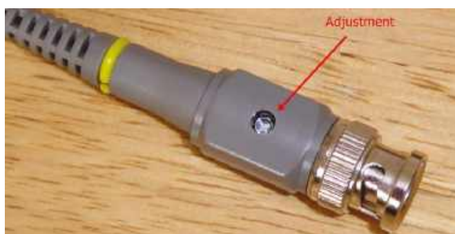
Fotografia 13. Regulacja kompensacji przy złączu do wejścia oscyloskopu
