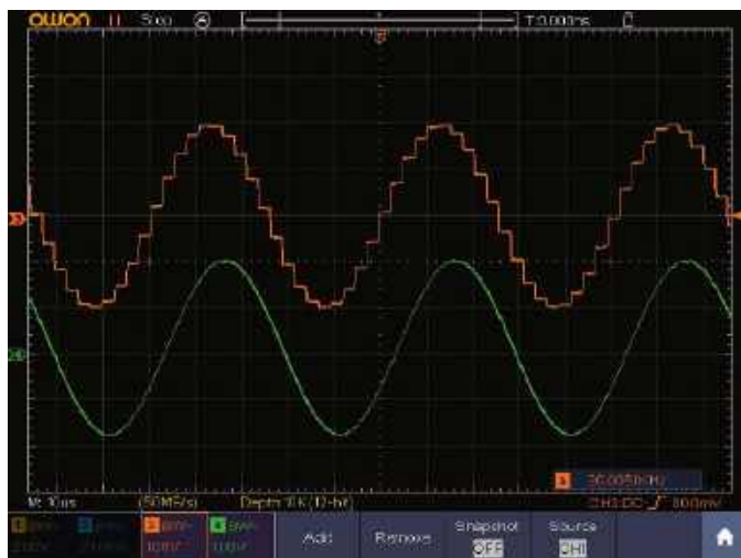
Oscylogram 3. Surowe wyjście sinusoidalne przetwornika cyfrowo-analogowego (DAC) o częstotliwości 20 kHz (pomarańczowa krzywa) wykazuje skoki z częstotliwością 384 kHz spowodowane nadpróbkowaniem przetwornika. Wyjście układu filtrującego (zielona krzywa) wygładza te skoki
