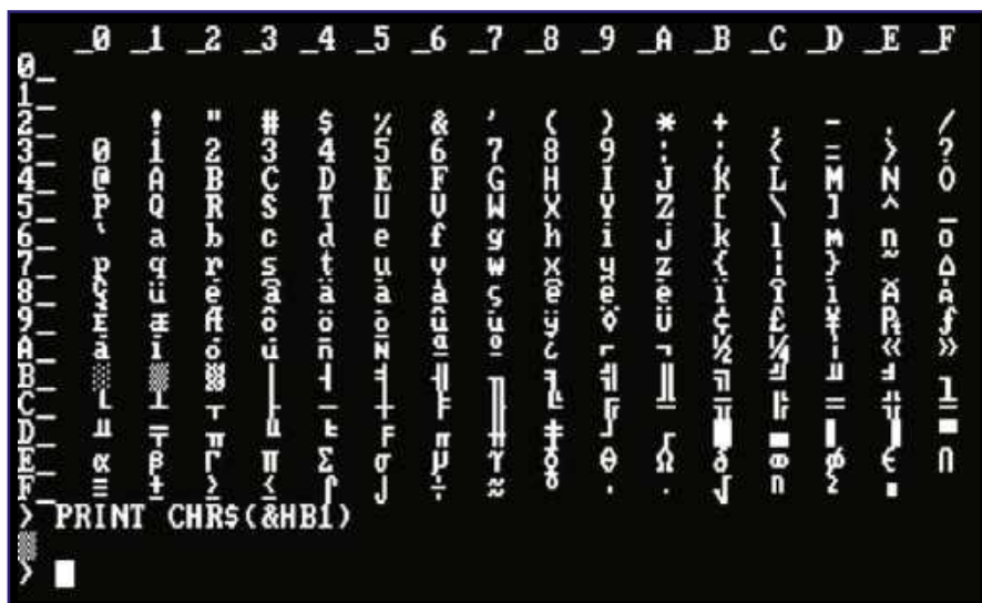
Zrzut ekranu 7. Czcionka zawiera znaki rozszerzone ze strony kodowej 437 używanej w oryginalnym komputerze IBM PC. Są tam symbole i znaki, które można wykorzystać do wyświetlania ramek, równań matematycznych i grafiki o małej rozdzielczości. Jak wyświetlić na ekranie znak o kodzie rozszerzonym, pokazuje dolny wiersz programu w języku BASIC
