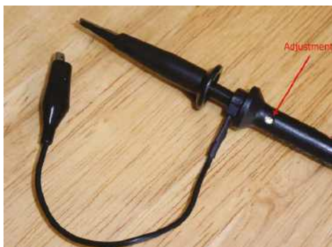
Fotografia 12. Regulacja kompensacji przy końcówce sondy oscyloskopowej
