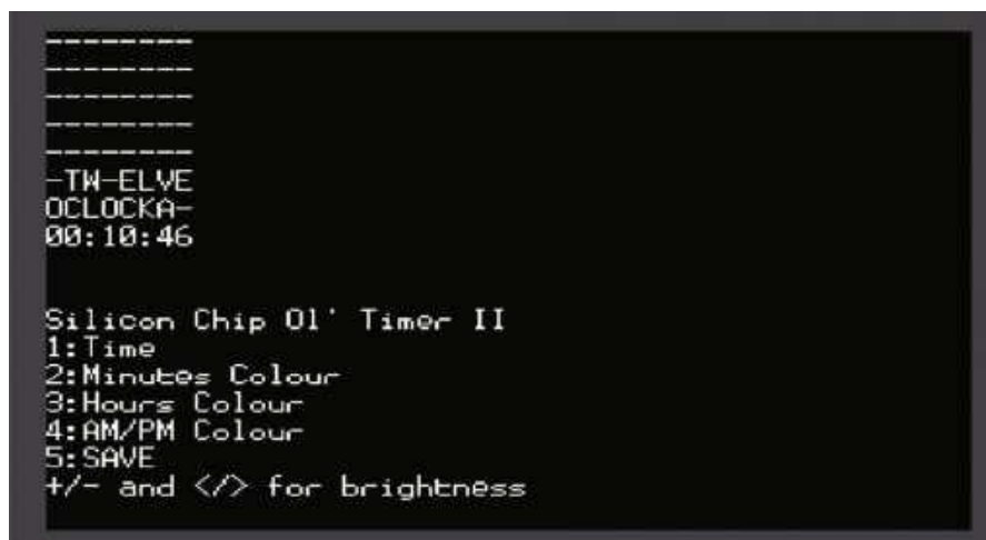
Zrzut ekranu 6. Z terminalem będzie współpracować wiele różnych urządzeń z interfejsami USB/UART, w tym większość opartych na układach PIC16F1455 i PIC16F1459. Oto projekt „Ol’ Timer II” z 2020 roku, skonfigurowany bez użycia komputera
