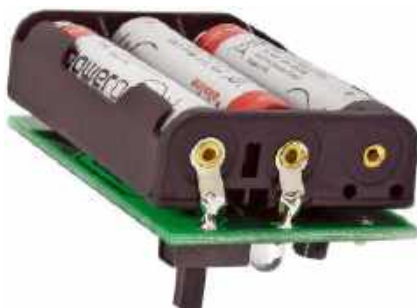
Fotografia 2. Poprawny montaż elektryczny koszyka baterii do płytki
