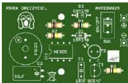
Rysunek 3. Rezystory o odpowiednich wartościach, oznaczone za pomocą kodu kolorowych pasków, zamontowane na właściwych pozycjach zgodnie z listą elementów
