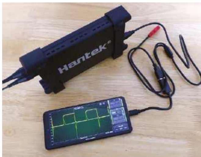
Fotografia 4. Hantek 6022BE w połączeniu ze smartfonem autora. Wyświetlacz, pomimo niewielkich rozmiarów, całkiem nieźle się sprawdza
