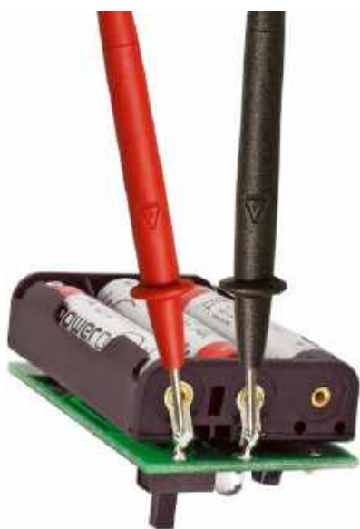
Fotografia 3. Pomiar napięcia na koszyku baterii
