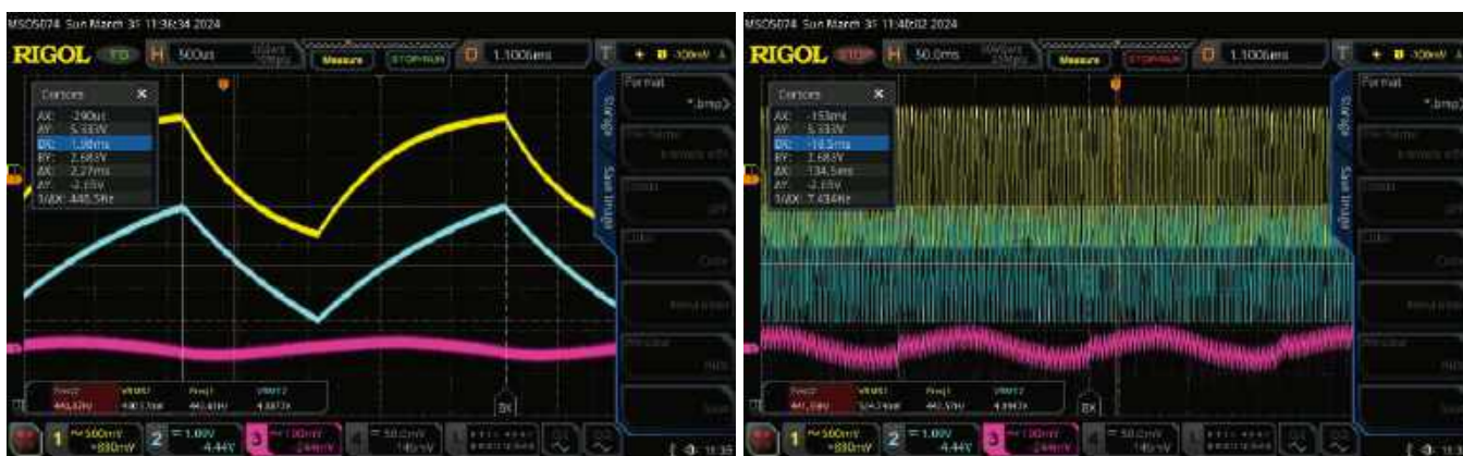
Oscylogramy 1 i 2. Na lewym oscylogramie pokazano ładowanie i rozładowywanie kondensatora o pojemności 1 µF przez układ czasowy 555 (kolor cyjanowy) oraz napięcie wyjściowe doprowadzone do głośnika dla dźwięku „A” o częstotliwości 440 Hz (kolor żółty). Napięcie sterujące (fioletowe) wynosi w tym przypadku około 5,3 V DC, choć nałożona jest na nie składowa zmienna o amplitudzie około 50 mV pochodząca z wyjścia. Na prawym oscylogramie pokazano te same sygnały co na oscylogramie 1, ale przy szybszej podstawie czasu i z włączonym efektem wibrato, widocznym jako okresowe przesuwanie przebiegu
