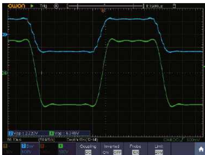
Oscyllogram 2. Umieszczenie pojedynczej próbki w połowie odległości między poziomem wysokim i niskim w znacznym stopniu eliminuje przeregulowanie sygnału
