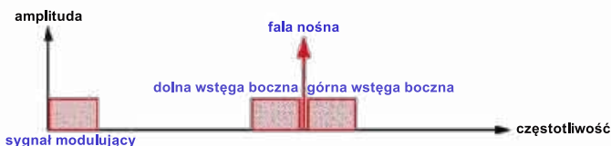
Widmo częstotliwościowe sygnału złożonego z modulacją AM (© 2026 Jos Verstraten)
