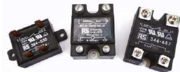
Rysunek 2.19. Przekładniki półprzewodnikowe przeznaczone do sterowania obciążeniami w sieci energetycznej prądu przemiennego, o maksymalnym prądzie obciążenia 10 A...45 A
