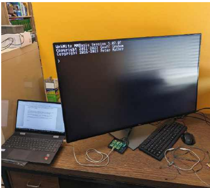
Terminal (dla porównania wielkości leżący obok 15-calowego laptopa), podłączony do 40-calowego monitora i płytki WebMite. Tekst jest wyraźny, nawet gdy na ekran pada światło słoneczne. Jeśli szukacie wyświetlacza większego niż 3,5-calowy ekranik LCD, terminal będzie tutaj oferował wiele możliwości
