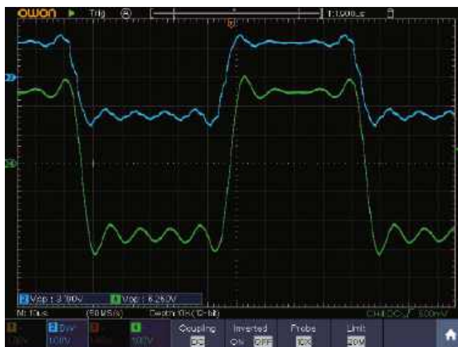
Oscylogram 6. Przebieg prostokątny o częstotliwości 10 kHz na wyjściu przetwornika cyfrowo-analogowego (niebieska krzywa) oraz po filtrowaniu (zielona krzywa). Oba wykazują znaczne przeregulowanie w porównaniu z ulepszoną wersją (patrz oscylogram 2)
