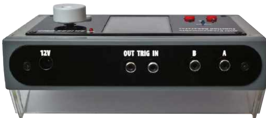
W górnej części generatora funkcyjnego znajdują się cztery gniazda RCA dla dwóch kanałów wyjściowych oraz wejścia i wyjścia wyzwalającego, a także koncentryczne gniazdo zasilania. Urządzenie pokazano tutaj na opcjonalnym stojaku
