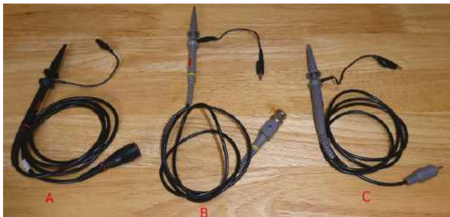
Fotografia 11. Trzy różne sondy oscyloskopowe (opis w tekście)
