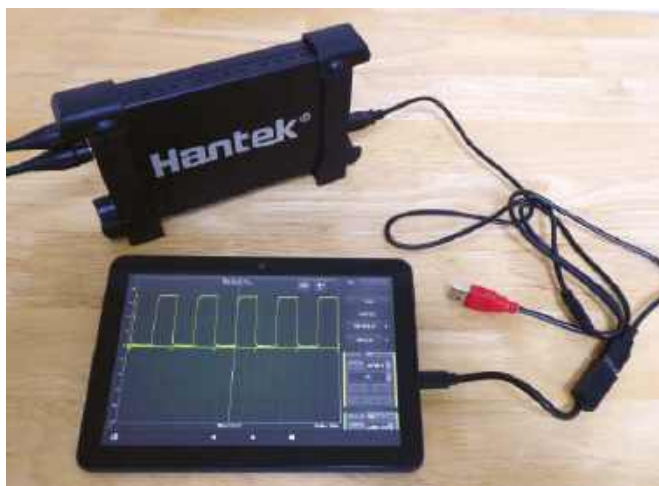
Fotografia 3. Oscyloskop Hantek 6022BE używany w połączeniu z tabletem Amazon Fire z systemem Android. Taka konfiguracja doskonale sprawdza się w zastosowaniach przenośnych
