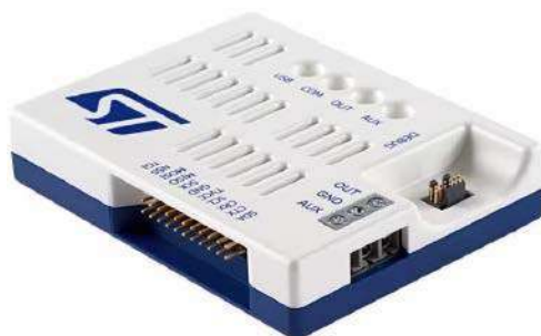
Fotografia 2. Programator/debugger z wbudowaną jednostką SMU – STLINK-V3PWR marki ST Microelectronics ( http://t.ly/-lu07 )
