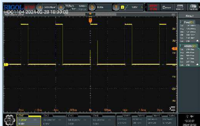
Rysunek 16. Prawidłowy przebieg sygnału PWM i jego statystyki (zakładka po prawej stronie ekranu oscyloskopu)
