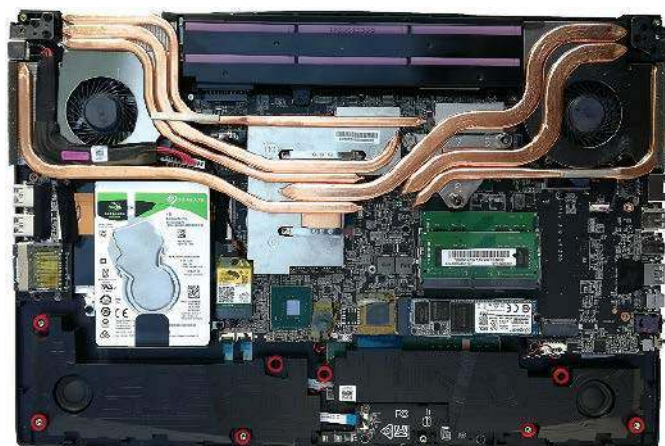
Fotografia 29. Wnętrze laptopa z widocznym systemem rurek ciepła oraz dwoma wentylatorami promieniowymi ( http://t.ly/XSYea )
