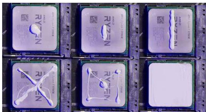
Fotografia 20. Sześć różnych sposobów dozowania pasty termoprzewodzącej na powierzchni obudowy procesora komputerowego ( http://t.ly/dQeog )
