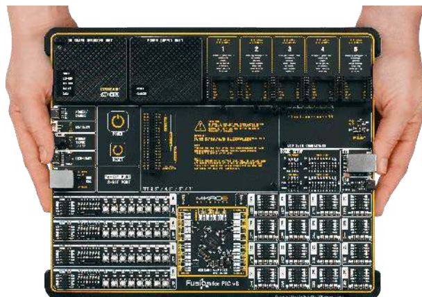
Fotografia 6. Płyta bazowa 8. generacji – Fusion marki MikroElektronika, przeznaczona do pracy z mikrokontrolerami PIC, dsPIC, PIC24 oraz PIC32 ( http://t.ly/P7JlJ )
