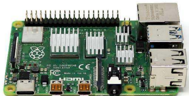
Fotografia 7. Minikomputer Raspberry Pi z radiatorami zamontowanymi na układach scalonych metodą klejenia ( http://t.ly/F1F-S )
