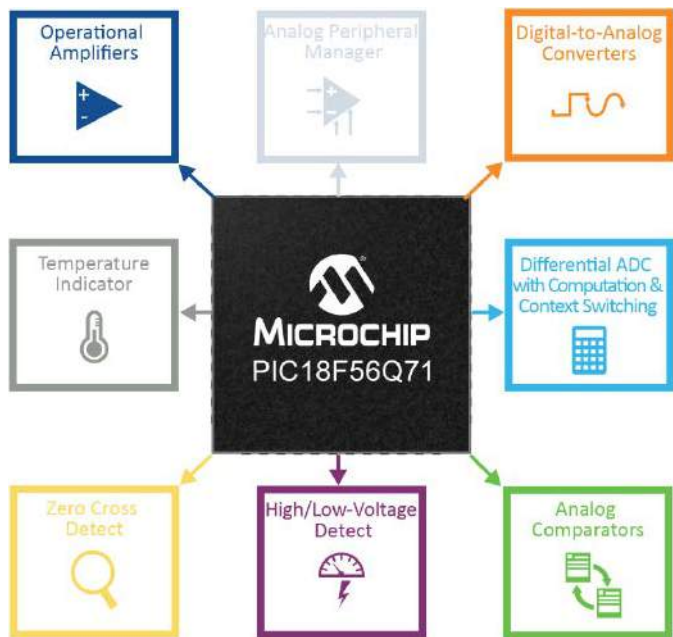
Rysunek 1. Mikrokontrolery ze zintegrowanymi peryferiami analogowymi pomagają projektantom obniżyć koszty i skrócić czas wprowadzenia produktu na rynek, jednocześnie poprawiając responsywność systemu
