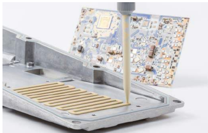
Fotografia 21. Zastosowanie automatycznego dyspensera do nakładania pasty termoprzewodzącej na wewnętrzną powierzchnię metalowej obudowy ( http://t.ly/djH62 )
