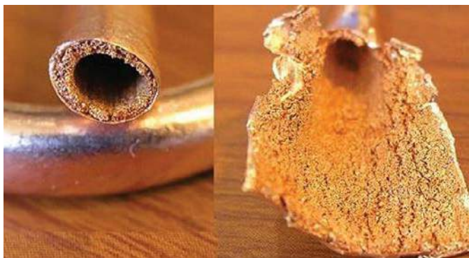
Fotografia 28. Przekroje poprzeczne rurek ciepła wykonanych w dwóch różnych technologiach ( http://t.ly/g-3Da )
