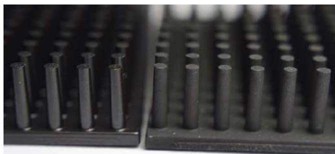
Fotografia 13. Porównanie powłok radiatorów wykonanych metodą E-Coating (po lewej) oraz przy pomocy zwykłego anodowania (po prawej). Źródło: http://t.ly/Q10Bg
