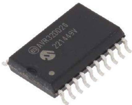
Fotografia 2. Mikrokontroler AVR32DD20-ISO z serii AVR DD
