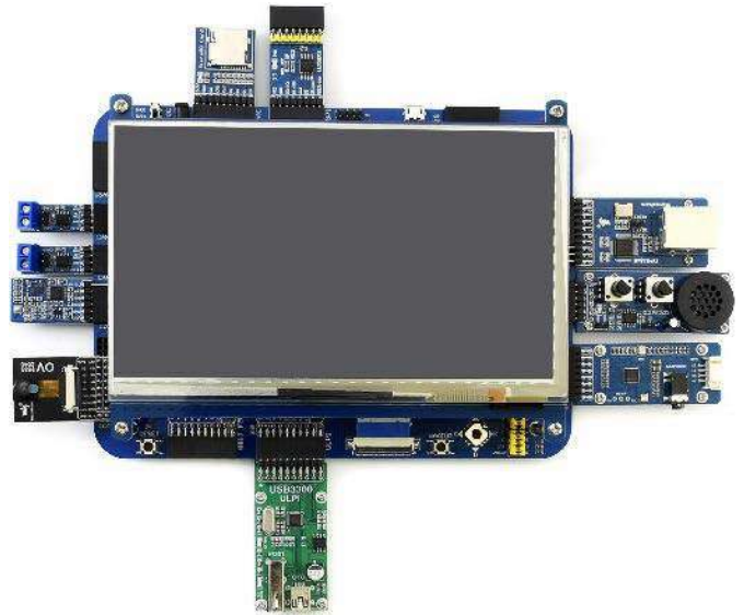
Fotografia 10. Płyta STM32 Open z zamontowanym wyświetlaczem graficznym i szeregiem modułów dodatkowych ( http://t.ly/91LdE )
