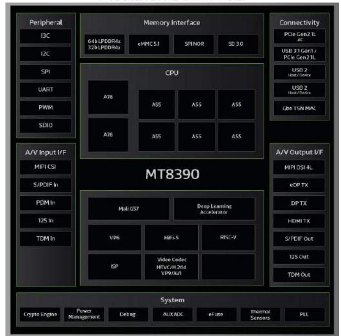
Rysunek 1. Uproszczony schemat blokowy procesora MediaTek Genio 700 (t.ly/W08Cm)
