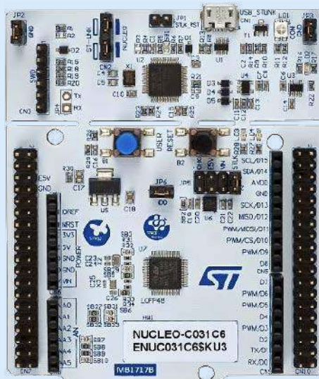
Fotografia 2. Widok płytki ewaluacyjnej NUCLEO-C031C6 ( http://t.ly/QLij7 )
