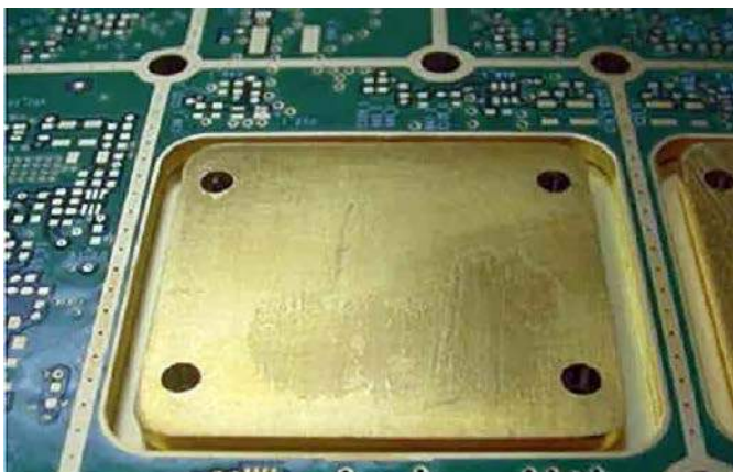
Fotografia 34. PCB z wkładką miedzianą (copper coin) umieszczoną we wnęce PCB (cavity) ( http://t.ly/OZ9xW )
