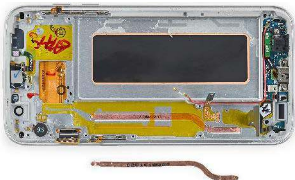
Fotografia 4. Wnętrze smartfona Samsung Galaxy S7 wraz z zastosowaną w nim rurką ciepła ( http://t.ly/TKLoC )
