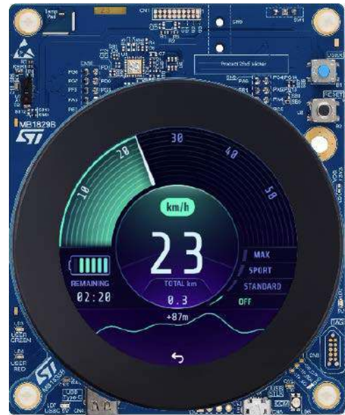
Rysunek 3. Zestaw deweloperski Discovery z układem STM32U5-5A9NJH6Q do testowania możliwości graficznych układu
