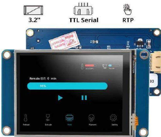
Fotografia 4. Przykładowy wyświetlacz inteligentny z serii Nextion marki IteadStudio
