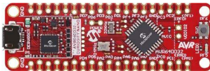
Fotografia 4. Niewielka płytka PCB stanowi pełny zestaw uruchomieniowy do mikrokontrolerów z serii AVR DD
