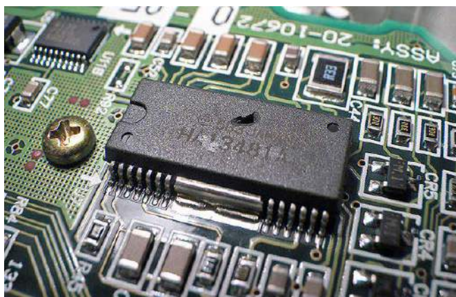
Fotografia 3. Przykład uszkodzenia obudowy układu scalonego na skutek intensywnego przegrzania struktury półprzewodnikowej ( http://t.ly/2LcCz )
