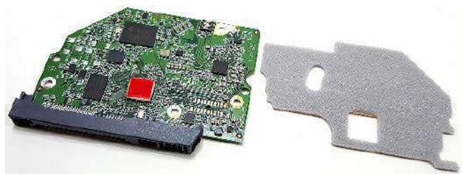
Fotografia 14. Kontroler dysku głównego z widocznym padem termicznym (czerwony kwadrat) zamontowanym na obudowie układu scalonego. Widoczny po prawej stronie szary element to pianka ochronna ( http://t.ly/ruh_ )
