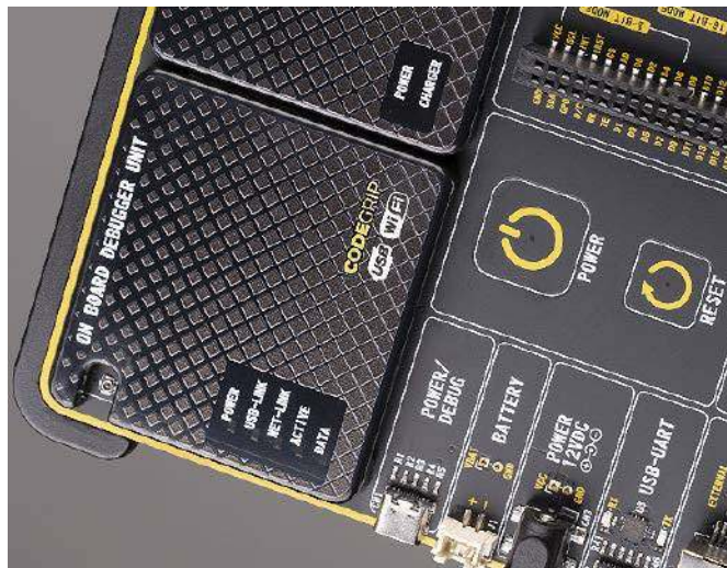
Fotografia 7. Moduły programatora/debuggera oraz zasilacza na płycie Fusion marki MikroElektronika ( http://t.ly/P7JlJ )
