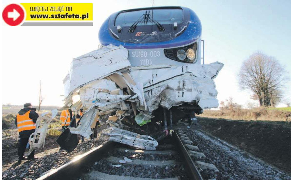
Elementy rozerwanej karoserii wbiły się w zderzak lokomotywy
