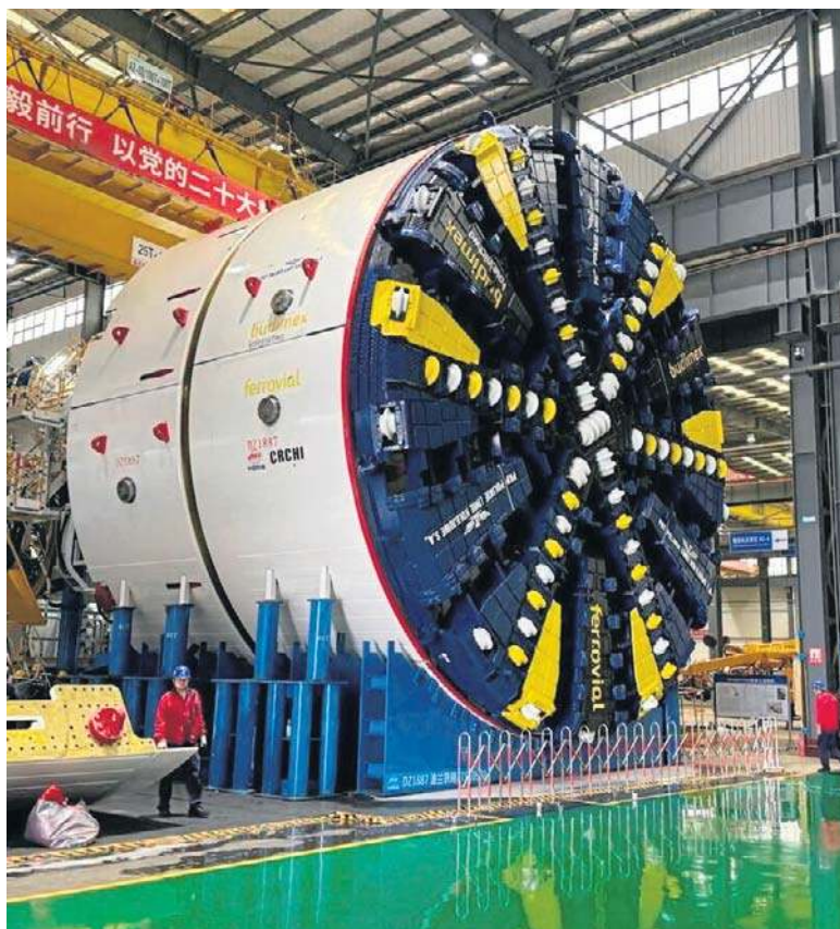
Tarcza, która wydrąży tunel w Suchorabie, przechodzi testy w Chinach
