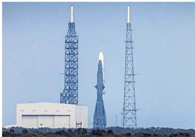
Raketa New Glenn ma 98 metrów wysokości i może wynieść na orbitę okołoziemską nawet 45 ton ładunku
