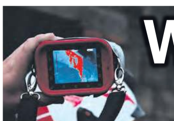
Na bieżąco sprawdzano kamerą termowizyjną temperaturę pobliskich budynków.
