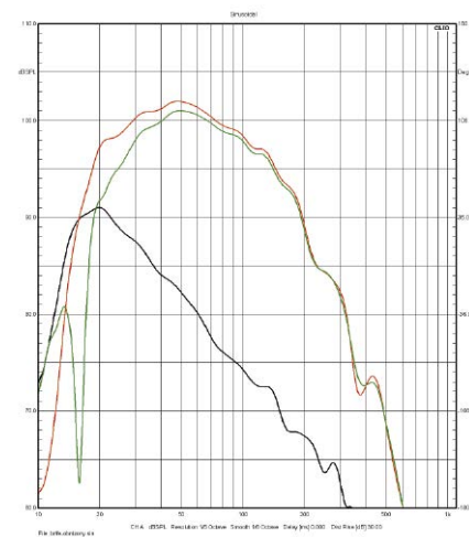
Rys. 5. Strojenie bas-refleksu, filtrowanie 200 Hz, profil Music.
