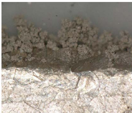
2. Ilustracja zjawiska powstawania dendrytów na elektrodzie ogniwa litowo-metalowego
