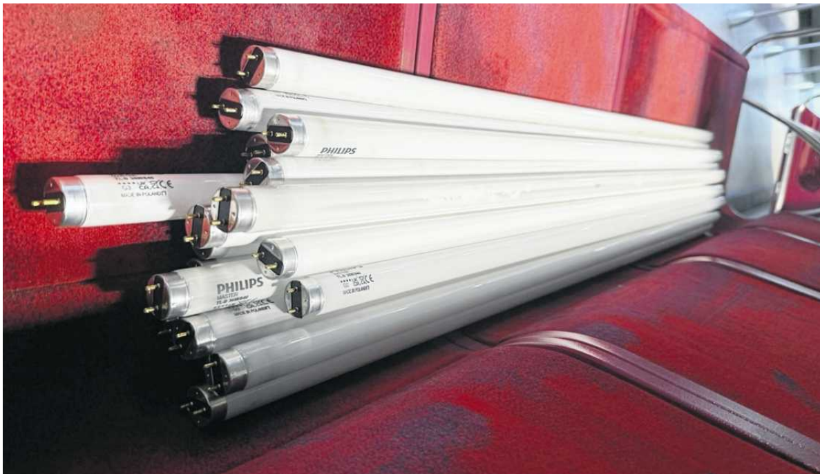
• Trwa wymiana świetlówek na nowego typu lampy ledowe we francuskich wagonach Metropolis FOT. METRO WARSZAWSKIE
