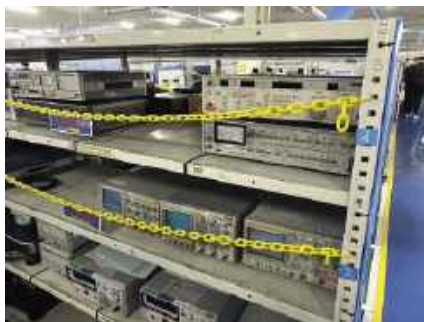
W wydzielonej strefie jest do dyspozycji sprzęt pomiarowy, generatory i analizatory sygnału.
