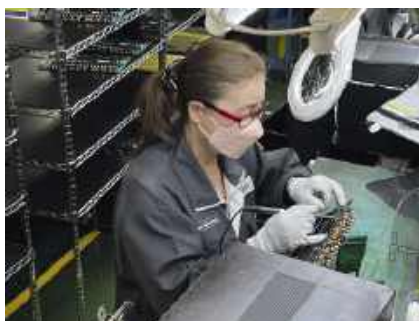
Nie wszystko da się wlutować maszynowo, część prac wykonuje człowiek.
