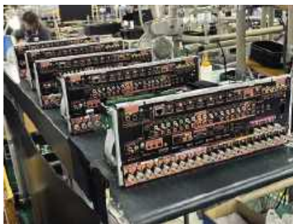
Marantz Cinema 30 – gotowe moduły tylnych ścianek z elektroniką zostaną za chwilę dokręcone do korpusu i podłączone.
