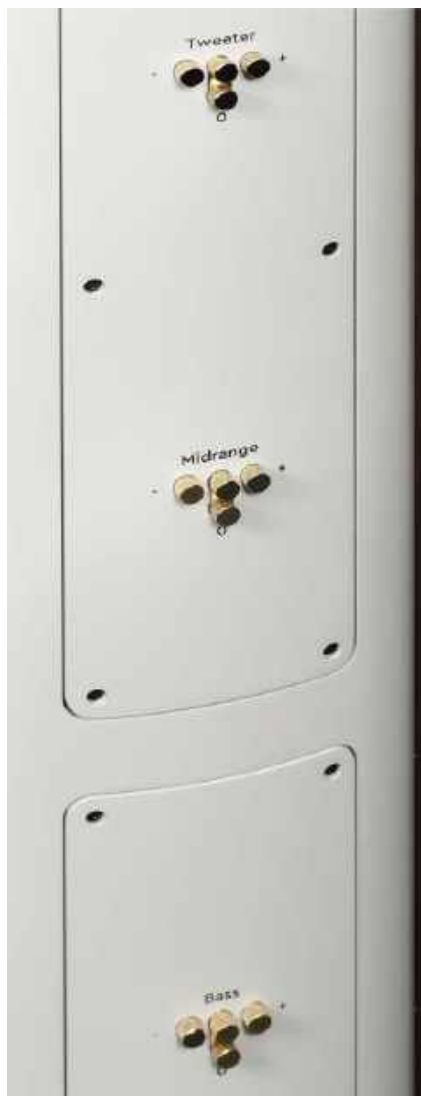
Regulacje trzech podzakresów przygotowano w formie zestawów zacisków ze śrubami i przepinanej zwory.
