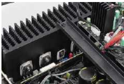
Każda końcówka ma własną płytkę i radiator (z dwoma parami tranzystorów na kanał).
