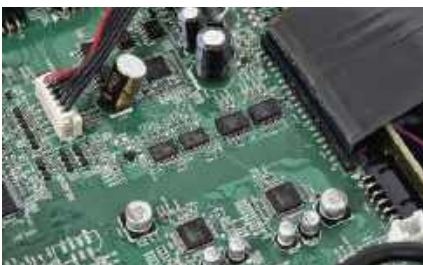
Zespół przetworników cyfrowo-analogowych składa się z niezależnych, stereofonicznych układów Burr Brown z rodziny PCM5100.
