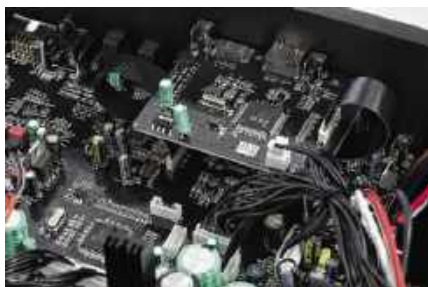
Sekcja cyfrowa składa się z dwóch płytek, konwertera DAC i niezależnego modułu HDMI.
