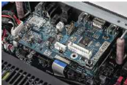
Wejście HDMI odseparowano od przetwornika C/A.
