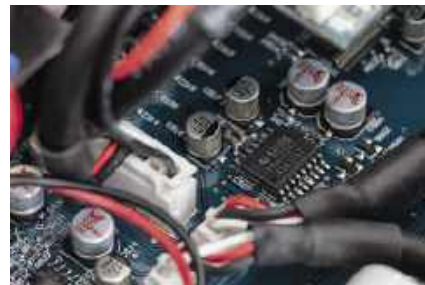
Regulacja głośności to zadanie dla nowoczesnego, scalonego tłumika.
