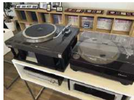
Denon budował jedno z najlepszych gramofonów z napędem bezpośrednim. DP-59M (manualna, a nie popularniejsza wersja automatyczna) i legenda – topowy DP-100 z odsprzęgniętym chassis.
