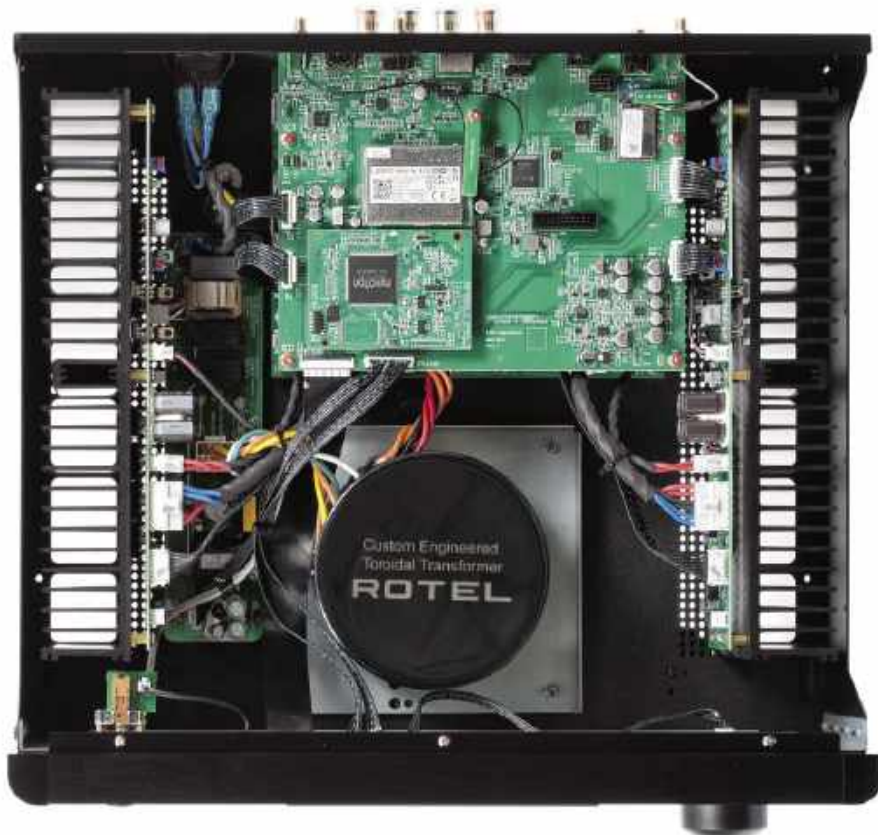
Wnętrze RAS-5000 w największym stopniu przypomina klasyczną analogową integrę; rozmieszczenie układów jest podporządkowane krótkiej ścieżce sygnału.
