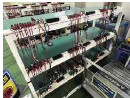
Stanowiska do pomiaru sekcji audio wzmacniaczy, w tym mocy wyjściowej.
