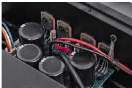
W niezależnych modułach końcówek mocy pracują po dwie pary układów Darlingtona.
