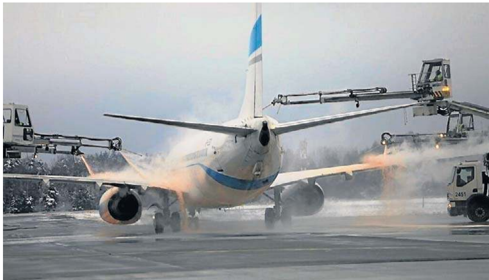
Odladzanie przypomina osobom postronnym mycie samolotu, ale to bardzo ważna czynność ze względów bezpieczeństwa
