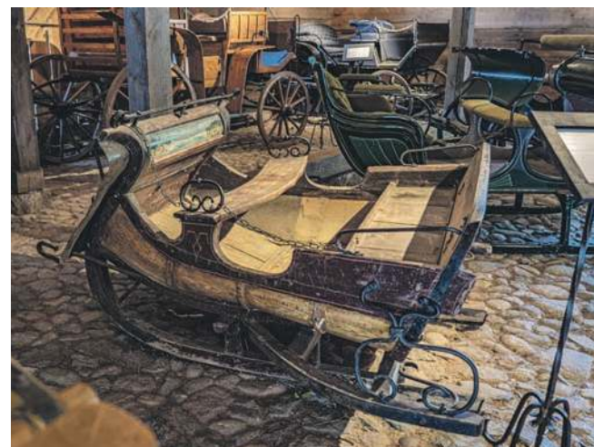
Sanie kuligowe z rejonu Podlasia z XXw. Uwagę zwracają ręczne zdobienia i malunki oraz specjalne płozy ułatwiające poruszanie się w głębokim śniegu.
