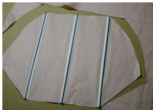
Dźwigary przyklejamy do płaszczyzny latawca
