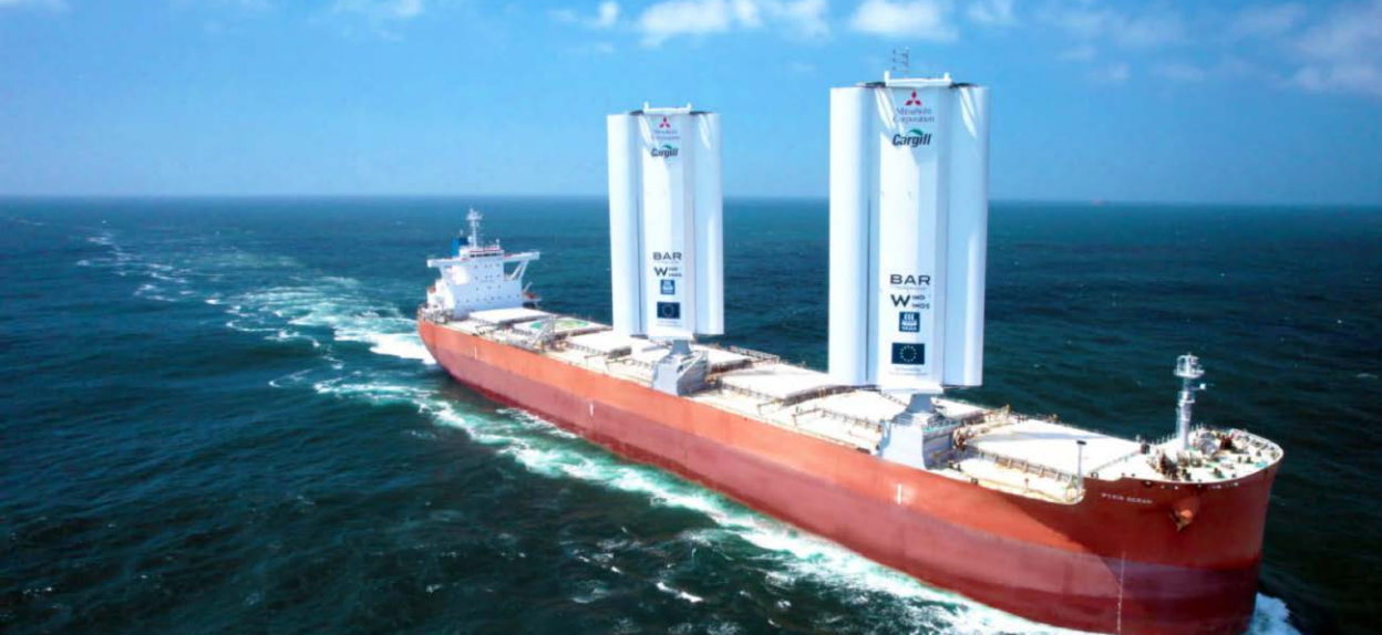
MV Pyxis Ocean wyposażony w dwa żagle „WindWings” od BAR Technologies (źródło: https://www.bartechologies.uk/project/pyxis-ocean/ )
