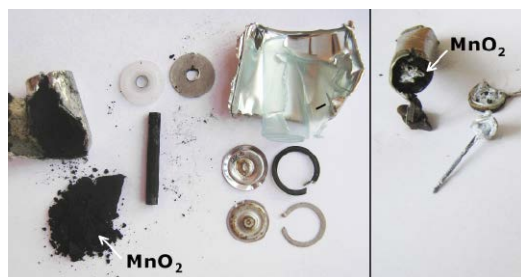
2. Rozłożone ogniwa zawierające dwutlenek manganu: z lewej ogniwo Leclanchégo, z prawej ogniwo alkaliczne (opis w tekście)
