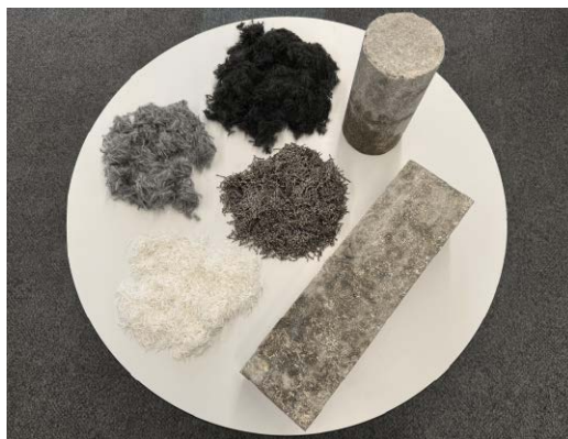
5. Próbkę betonu wzmocniane włóknami dywanowymi © Uniwersytet RMIT
