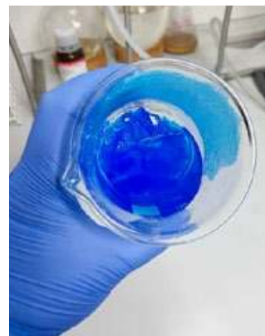
Fot. 3. Kryształy \text{CuSO}_4 \cdot 5\text{H}_2\text{O} na dnie zlewki z roztworem \text{CuSO}_4
