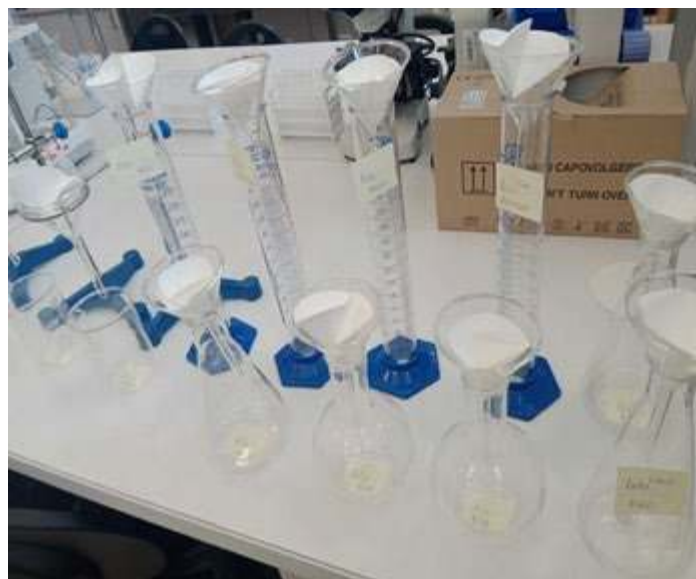
Fot. 2. Przygotowanie zestawu do sączenia roztworów.
