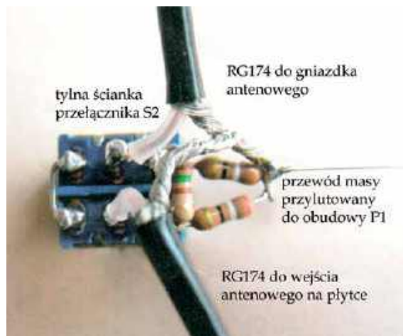
Rys. 6. Sposób podłączenia mechanicznego filtra FZ01 – FZ103
