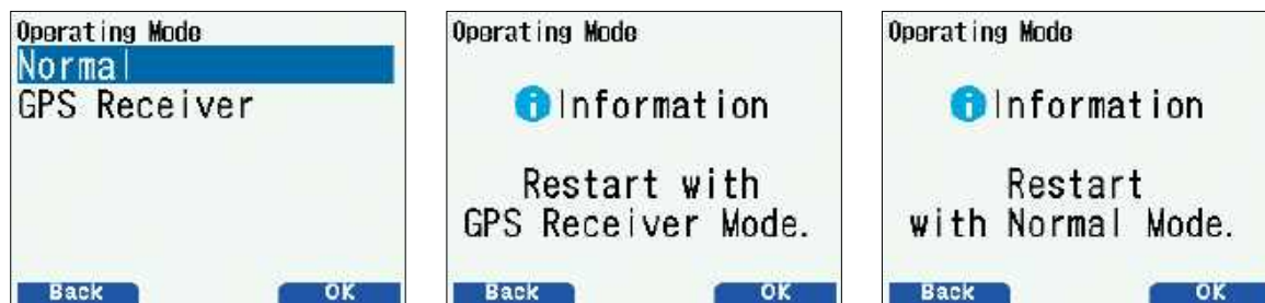
Rys. 17. Odbiornik GPS może pracować podczas włączonej części radiowej (Normal Mode) lub tylko jako sam odbiornik GPS z funkcją zapisu trasy na karcie microSD (GPS Receiver Mode), wówczas funkcje radiowe nie są dostępne (z wyjątkiem pasma komercyjnego WFM)
