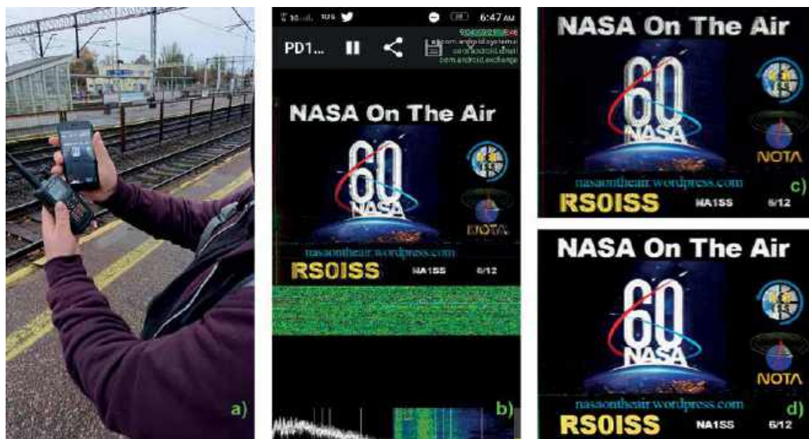
Rys. 14. Radiostacja TH-D74E była wykorzystywana do odbioru obrazów nadawanych z pokładu ISS i nagrywania odebranego dźwięku na kartę microSD. Na stacji (a) w Kutnie odbyła się prezentacja odbierania „melodii” nadawanej z Międzynarodowej Stacji Kosmicznej (Fot. M. Baran). Do celów prezentacji, co zawiera „melodia”, (b) dźwięk z głośnika TH-D74E był odbierany przez mikrofon telefonu z systemem Android i dekodowany aplikacją Robot36. Dźwięk nagrany na karcie microSD w TH-D74E był później skopiowany do komputera i zdekodowany programem MMSSTV (d). Nie widać z tak nagranych plików dźwiękowych niezgodności związanej z niedopasowaniem próbkowania dźwięku cyfrowego, który może być widoczny na zdekodowanych obrazach w postaci ukośnych pasów lub kropek podobnych do tych jak na (c)
