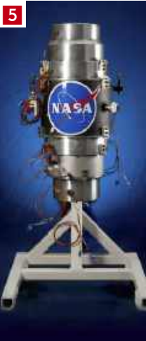
5. Opracowana przez NASA bateria z kołem zamachowym, 6. Stara pocztówka ukazująca kompleks hydroenergetyczny w Schaffhausen, 7. Ilustracja współczesnego systemu magazynowania energii z oze za pomocą kondensatorów, 8. Schemat japońskiego prototypowego SMES, 9. Magazyn energii oparty na akumulatorach litowo-jonowych, 10. Demonstracja systemu grawitacyjnego magazynowania energii firmy Gravitricity
