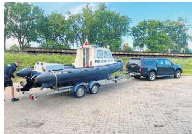
Łódź patrolowa typu Parker 650 wyposażona jest w zabudowany silnik wysokoprężny o mocy 170 KM.
