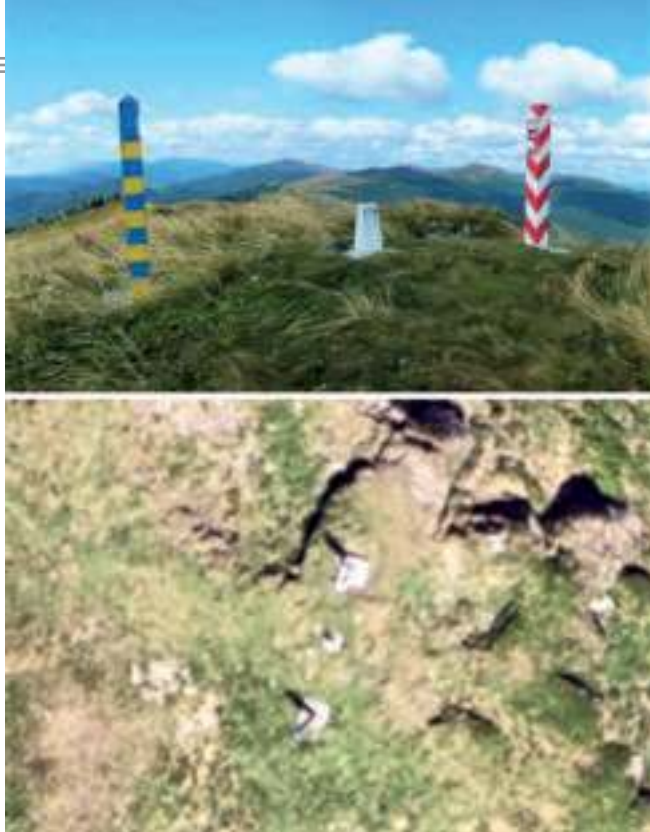
Znak graniczny na górze Kińczyk Bukowski i punkt geodezyjnej osnowy bazowej jako znak poligonowy pomiędzy słupami granicznymi Polski i Ukrainy; poniżej, obraz tych samych znaków granicznych na ortofotomapie, źródło: Jernej Prosinecki/Geoportal.gov.pl
