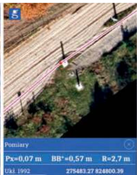
Przykłady różnicy w danych geodezyjnych pomiędzy obrazem znaków granicznych i odpowiadającym im punktem załamania linii granicznej; na granicy (kolejno) z Rosją, Białorusią i Ukrainą, źródło: Geoportal.gov.pl
