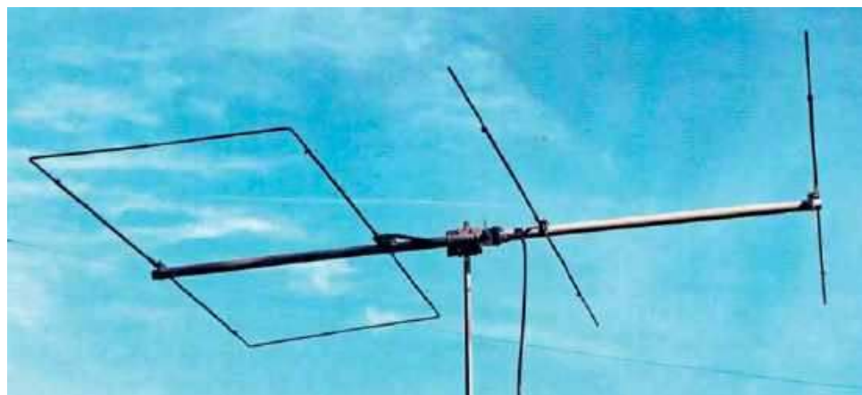
Rys. 1. Szkic anteny Moxon na pasmo 6 m
