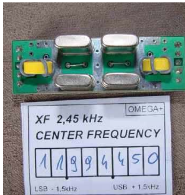
Filtr kwarcowy 12 MHz stosowany w TRX OMEGA
