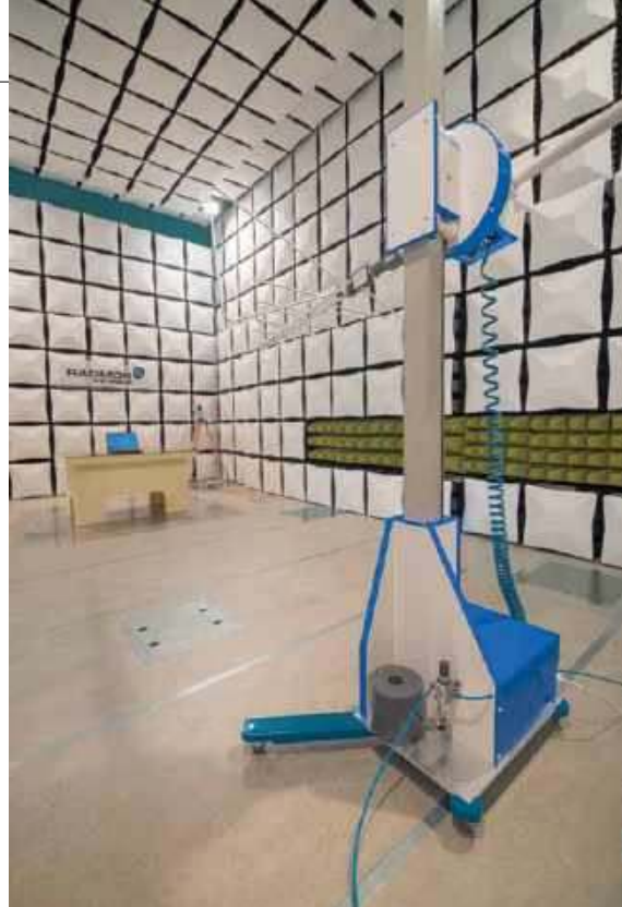
Stanowisko pomiarowe do badań emisji promieniowanej
