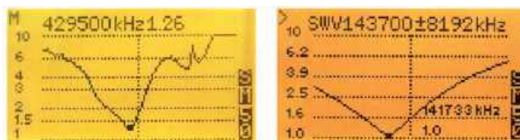
Rys. 2. Charakterystyki SWR anteny (od lewej) na 70 cm i na 2 m
