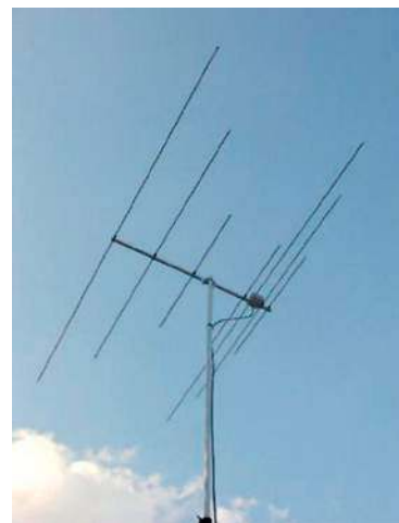
Fot. 1. Widok anteny trzypasmowej DK7ZB
