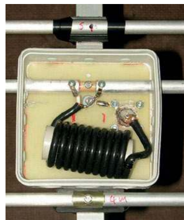
Fot. 2. Zasilanie anteny trzypasmowej
