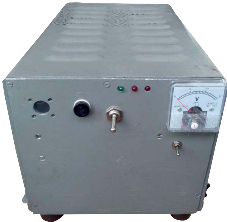
Widok zasilaczy WN DC (Ua i Us2) od strony płyty frontowej
