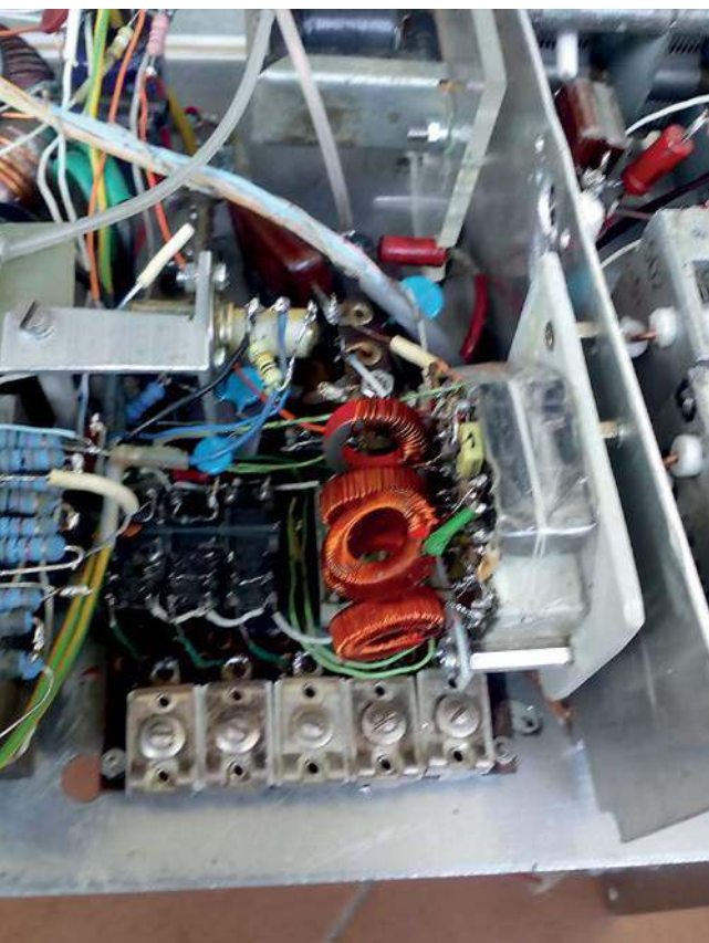
Pokazane są obwody w.cz. dopasowujące z niskiej impedancji wyjściowej KX3 do impedancji w obwodzie siatki sterującej GU-81M
