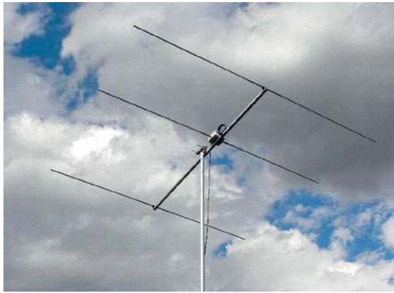
Fot. 5. Antena trzelementowa
