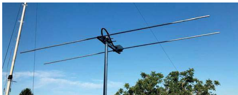
Fot. 3. Antena dwuelementowa wykonana przez DH0GSU
