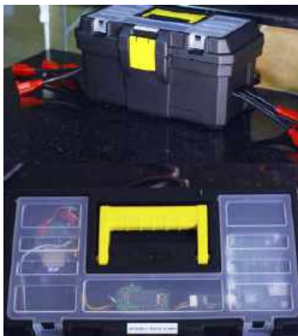
Fotografia 1. Gotowy układ w obudowie z plastikowej skrzynki na narzędzia
