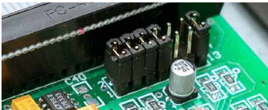
Fotografia 2. Umieszczenie zwerek konfiguracyjnych – złącze P6
