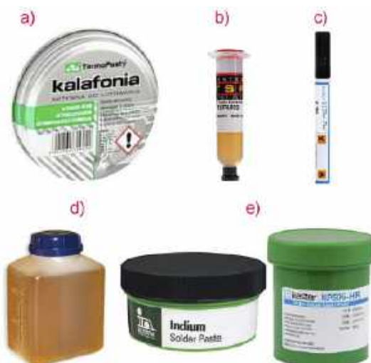
Fotografia 10. Topniki niezbędne do prawidłowego lutowania
