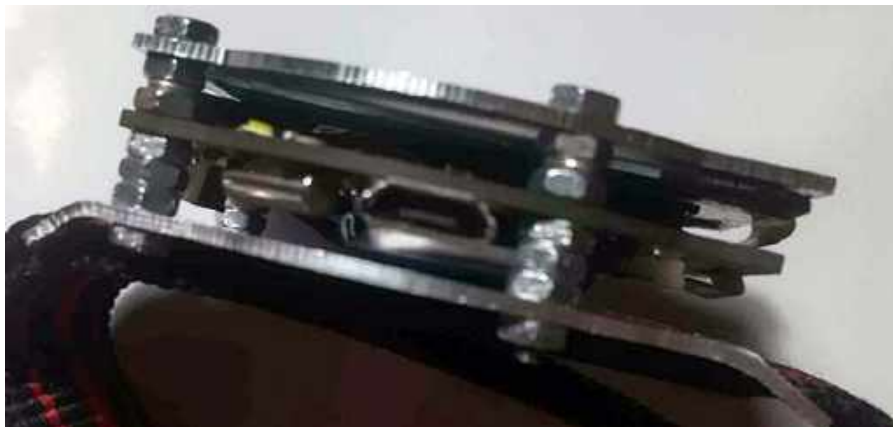
Fotografia 4. Sposób przykręcenia płytek
