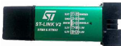
Fotografia 1. Programator-debugger kompatybilny z ST-LINK/V2 zastosowany w projekcie
