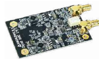
Fotografia 3. Wygląd ekspandera SYZYGY ZmodDAC1411 – 14-bitowego przetwornika C/A o częstotliwości próbkowania do 100 MHz
