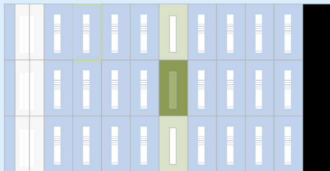
Rysunek 16. Położenie bloków pamięci w strukturze układu FPGA
