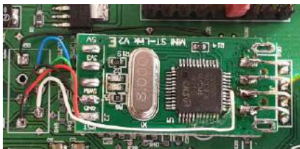
Fotografia 2. Sposób montażu programatora-debuggera dla mniej zaawansowanych
