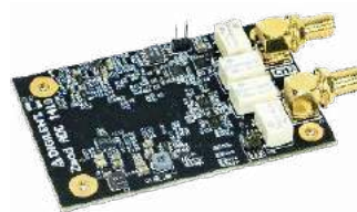
Fotografia 2. Wygląd ekspandera SYZYGY ZmodADC1410 – 14-bitowego przetwornika A/C o częstotliwości próbkowania do 100 MHz
