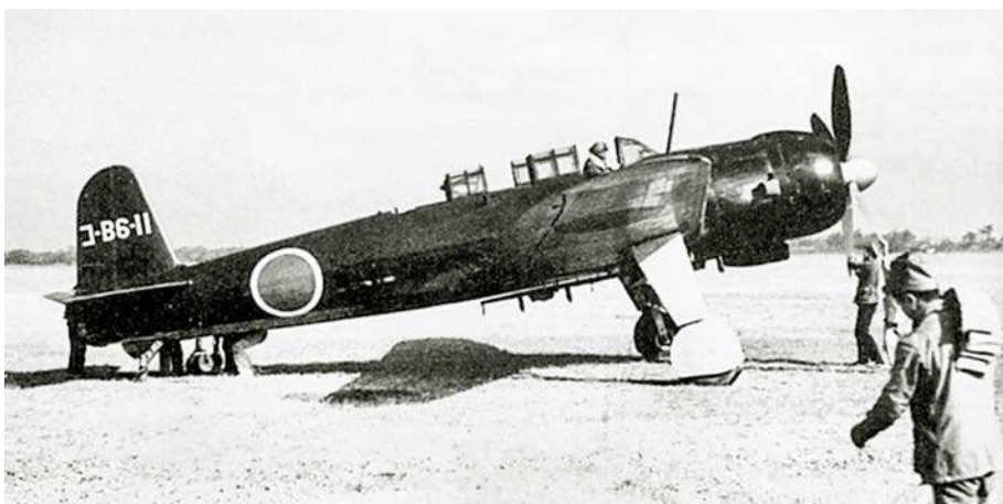
Prototyp B6N2 podczas prób w Wydziale Prób w Locie Arsenatu Techniki Lotniczej Marynarki Wojennej w bazie Oppama koło Yokosuki w lecie 1943 roku. Samolot ma zbiorcze rury wydechowe, ale krótsze i szersze niż B6N1. Widać podwieszoną pod kadłubem belkę z zaczepami dla dwóch bomb o masie po 250 kg (jedna za drugą) lub sześciu o masie po 60 kg (po dwie obok siebie, w trzech parach jedna za drugą).
