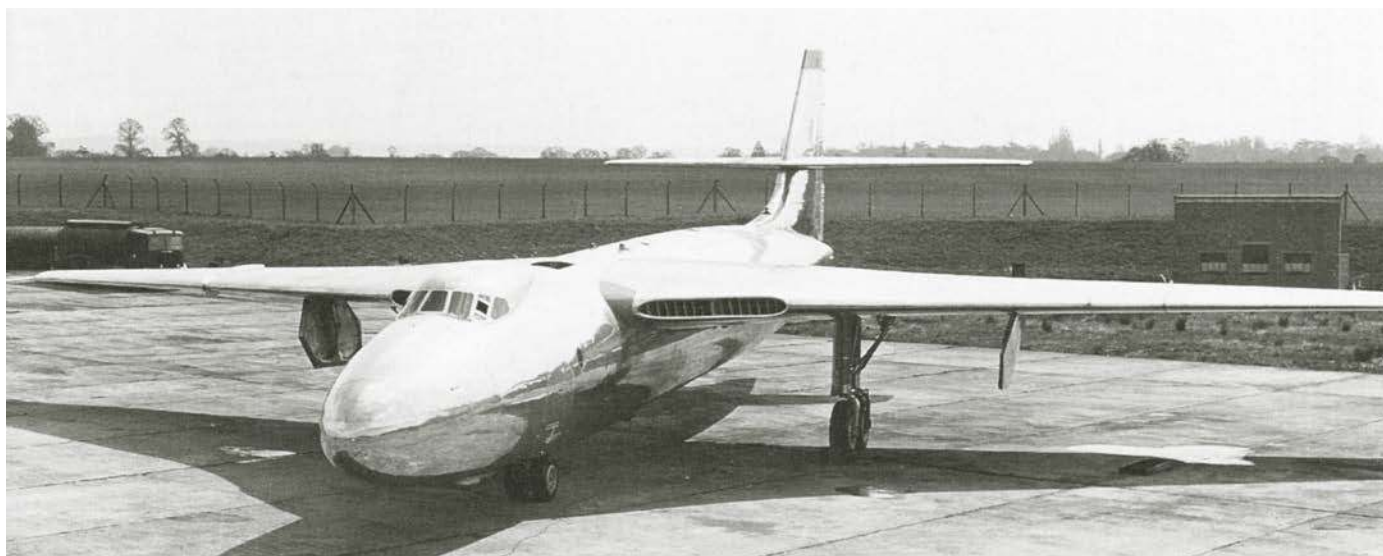
Pierwszy prototyp Valianta (WB210). Widać wąskie wloty powietrza do silników w krawędzi natarcia centroplata i charakterystyczne podwozie główne z dwoma kołami w układzie tandem. Samolot został utracony 12 stycznia 1952 roku wskutek wybuchu pożaru w locie.
