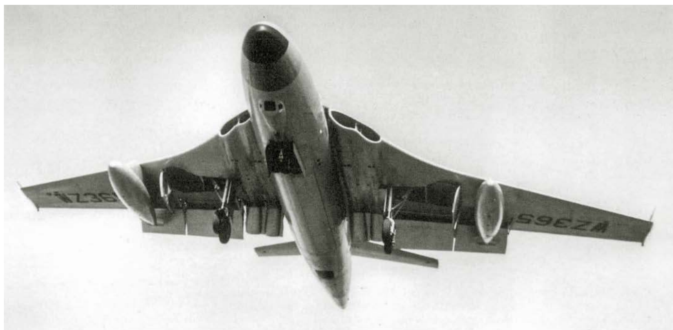
Valiant B.1 (WZ365) – jeden z 35 egz. tej wersji. Widać wychylone kłapy (wyprofilowane krokodylowe pod centropłatem i dwuszczelinowe pod zewnętrznymi sekcjami skrzydeł). Później ten egzemplarz został przystosowany do zadań RCM.
