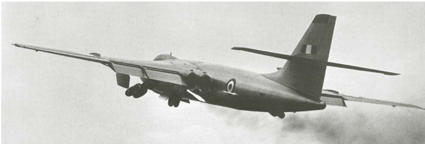
Drugi prototyp Valianta (WB215) podczas prób z raketowymi przyspieszaczami startowymi (RATOG) na paliwo ciekłe de Havilland Super Sprite , które podwieszano w specjalnych obudowach pod skrzydłami (pod silnikami odrzutowymi).
