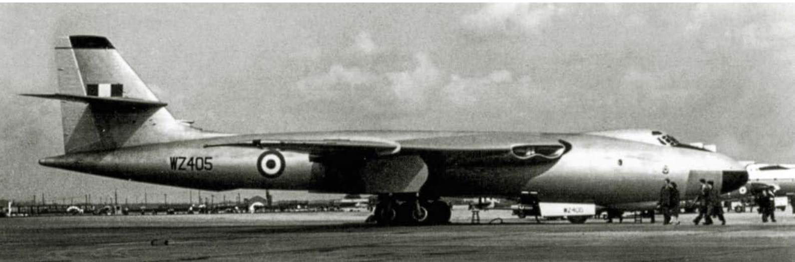
Valiant BK.1 (WZ405) z No. 207 Squadron. W samolotach tej wersji zrezygnowano z przenoszenia aparatów fotograficznych, ale zachowano zdolność do przekazywania paliwa w locie. Zbudowano 44 egz. BK.1.
