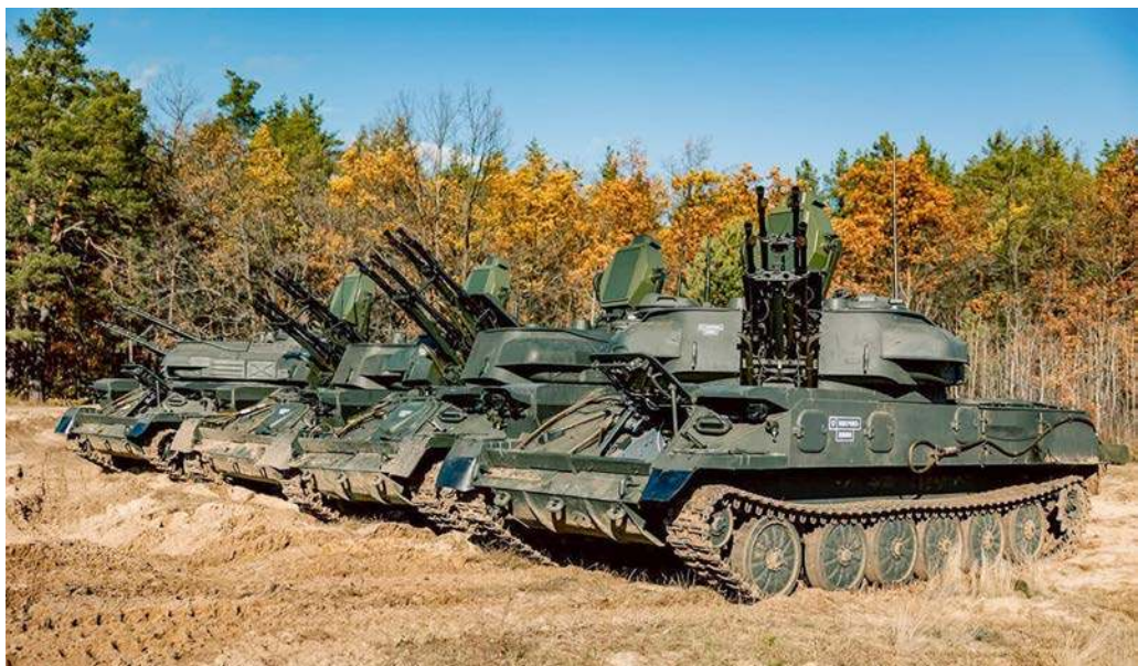
Cztery zmodernizowane ukraińskie zestawy plot. ZSU-23-4M-A1. Oryginalny radar Szytki zastąpiono stacją Rokacz-AS , która jest w stanie wykrywać i śledzić małe drony. Czas przetwarzania danych o celu został skrócony z 18 do zaledwie 0,2 sekundy. Maksymalny zasięg wykrywania wzrósł ponad dwukrotnie, przy czym możliwe jest śledzenie do 20 celów jednocześnie.
