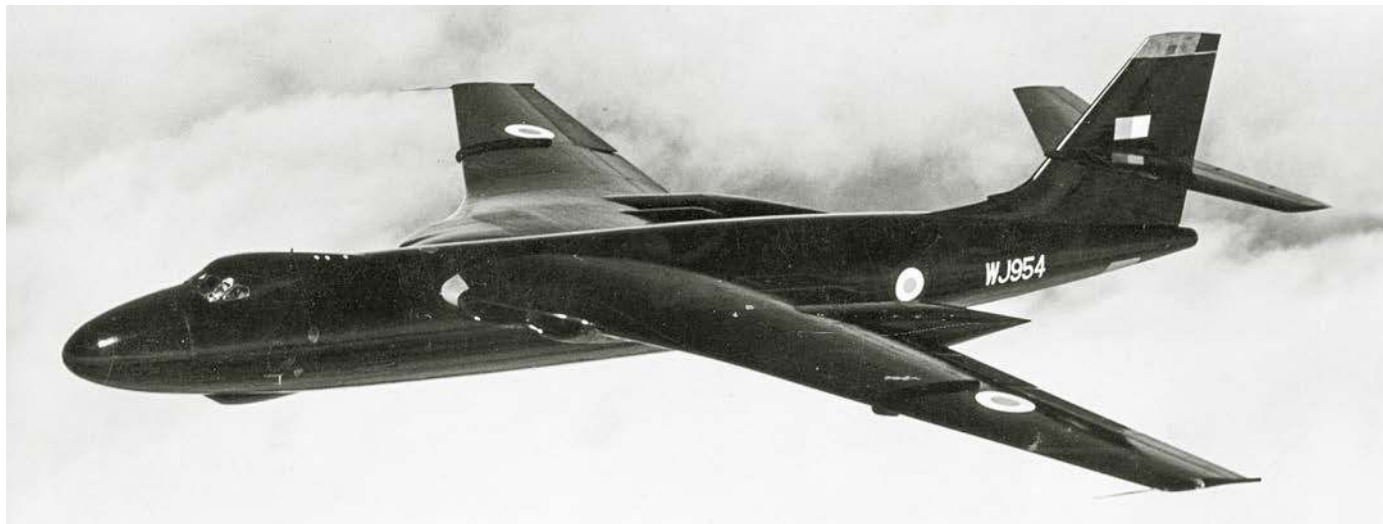
Prototyp Valianta B.2 (WJ954). Samolot mial sluzyc do identyfikowania i wskazywania celow ( target marker ; w RAF tego rodzaju samoloty nazywano popularnie pathfinder ) podczas lotu z duza prędkością na malej wysokości.
