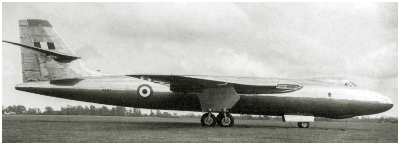
Pierwszy prototyp Valianta (WB210). Projekt powstał w odpowiedzi na specyfikację B.35/46, ale samolot został zbudowany według zmodyfikowanej specyfikacji B.9/48. Miał układ wolnonośnego górnopłata ze skośnymi skrzydłami i usterzeniem.
