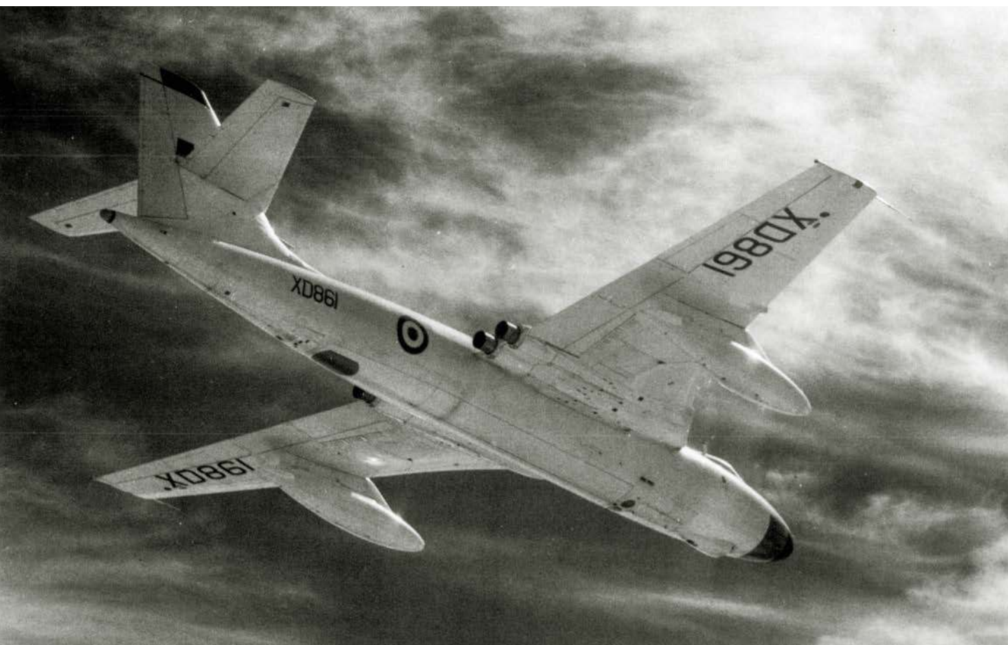
Valiant BK.1 (XD861) z No. 214 Squadron. Podskrzydłowe zbiorniki paliwa miały ogromną pojemność po 7478 l (1645 Imp. gal.), więc w obawie przed wyrządzeniem szkód na ziemi zrezygnowano z ich odrzucania w locie.
