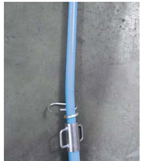
Fot. 1. Przykład podpory, która w trakcie badania wykazywała duże rezerwy nośności. Jednakże wybočenje uniemożliwia jej ponowne wykorzystanie. Dodatkowo, tak duże wygięcie powoduje u użytkownika poczucie zagrożenia. W takim przypadku trudno uznać za siłę niszczącą maksymalną wartość, jaką uzyska się w badaniu
