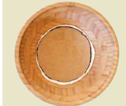
Fotografia 3. Do dna miski jest przytwierdzony krążek wzmacniający za pomocą akrylowego wypełniacza szczelin. Zanim to zrobisz, upewnij się, że jest dobrze dopasowany, pozostawiając szczelinę o szerokości mniejszej niż 5 mm dookoła
