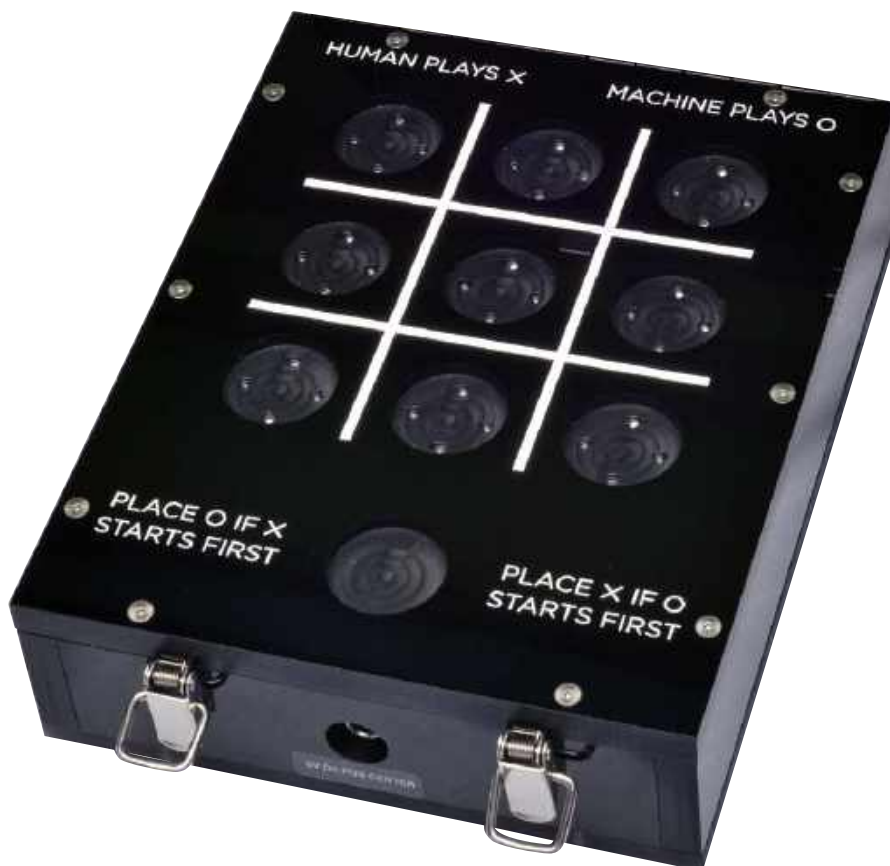
Kompletna obudowa bez pokrywy. Zwróć uwagę na soczewki LED wystające przez cztery otwory w każdym wgłębieniu o średnicy 20 mm oraz wpuszczone gniazdo zasilania z przodu
