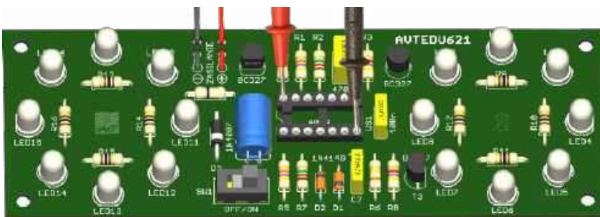
Rysunek 17. Pomiar napięcia zasilającego układ scalony na odpowiednich wyprowadzeniach podstawki po ustawieniu przełącznika SW1 w pozycję ON. Użyj schematu ideowego by ustalić właściwe wyprowadzenia
