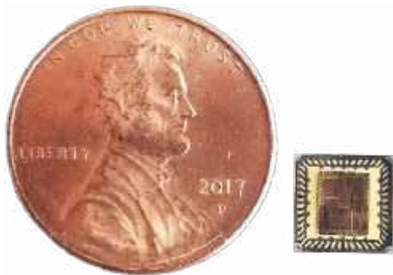
Rysunek 2. Układ System-on-Chip Mantis AIS obok amerykańskiej jednocentówki o średnicy 19 mm (źródło: AIStorm)
