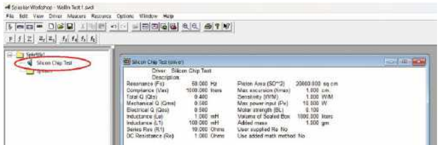
Zrzut ekranu 7. Aby używać przystawki z programem Speaker Workshop, należy utworzyć instancję „głośnika” i ustawić kilka istotnych parametrów
