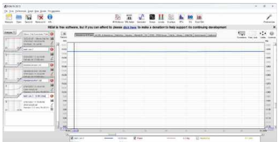
Zrzut ekranu 4. Kalibracja z rezystorem odniesienia 10 Ω została zakończona. Wynik prawie dokładnie odpowiada wskazaniu, jakie uzyskaliśmy na omierzu
