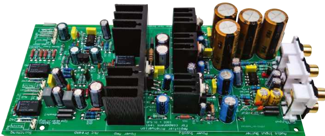
Zmontowana płytko drukowana, gotowa do przyłączenia panelu przedniego poprzez osiem złączy kątowych. Złącza ułatwiają podłączenie i odłączenie, gdy układ jest już zamontowany w obudowie
