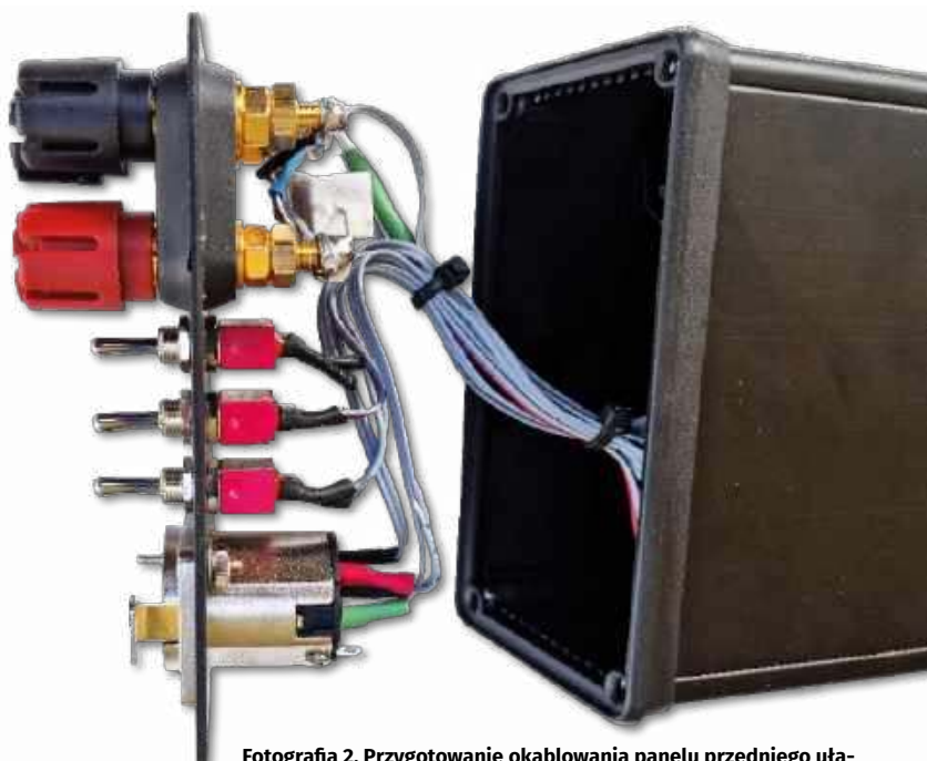
Fotografia 2. Przygotowanie okablowania panelu przedniego ułatwiają rurki termokurczliwe i opaski kablowe. Zwróćmy uwagę na rezystor odniesienia 10 Ω przyłączony do zacisków złącza głośnikowego
