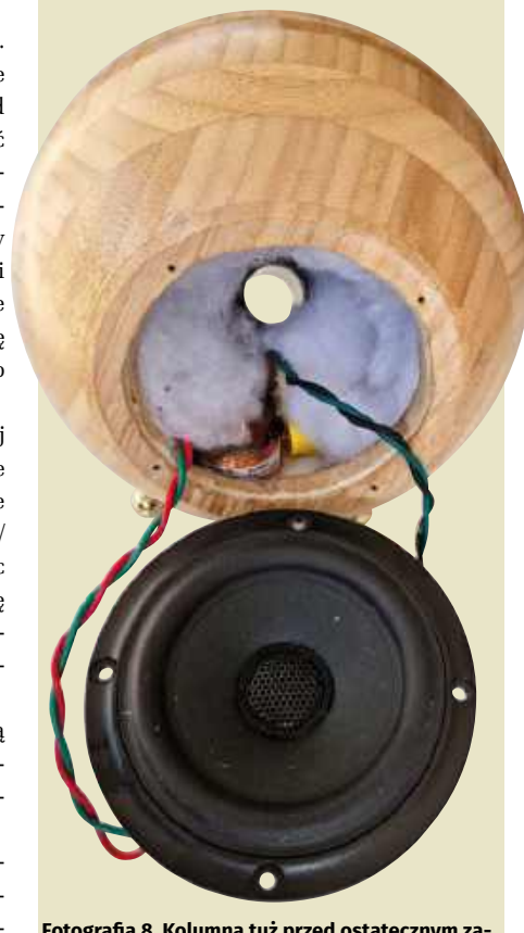
Fotografia 8. Kolumna tuż przed ostatecznym zamocowaniem głośnika, z luźno upchaną w środku watą akustyczną
