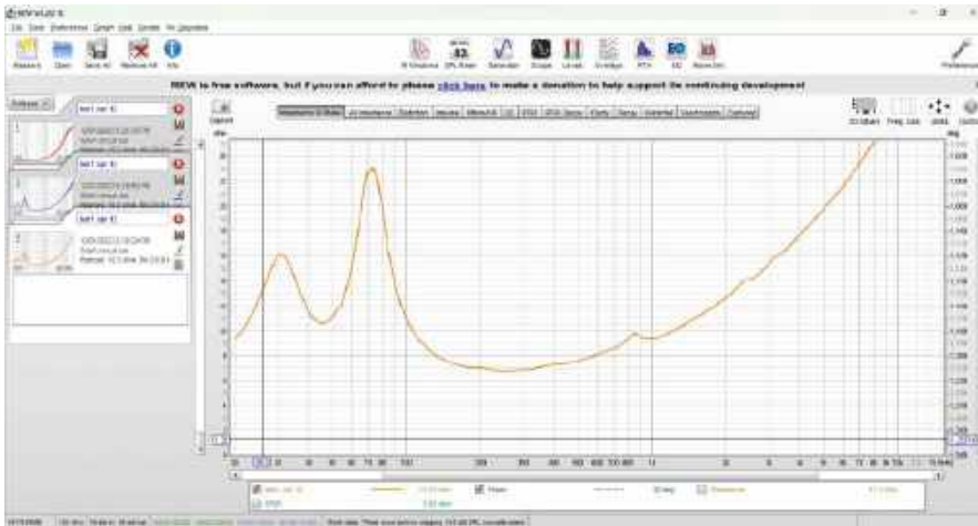
Zrzut ekranu 5. Pomiar impedancji subwoofera wykonany przy użyciu programu REW i przystawki. Uzyskaliśmy ładny, gładki wykres wykazujący maksima rezonansowe przy około 31 Hz i 72 Hz (głośnik i obudowa) oraz 850 Hz i 2,5 kHz (dzielenie się membrany i podobne zjawiska)
