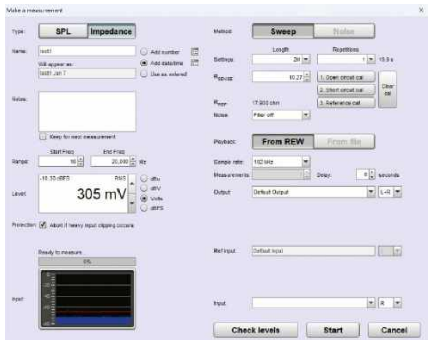
Zrzut ekranu 3. Tu wykonujemy pomiary impedancji i charakterystyki częstotliwościowej
