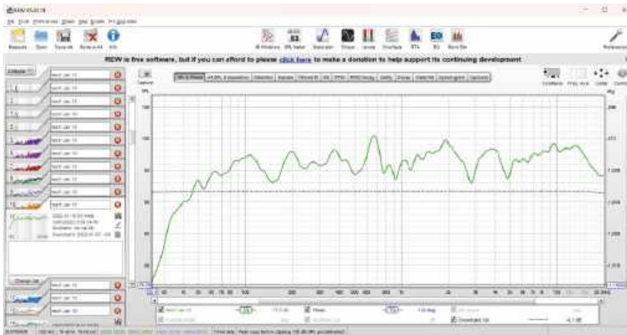
Zrzut ekranu 6. Wykres charakterystyki częstotliwościowej szerokopasmowego zestawu głośnikowego wykonany w programie REW. Tęgo rodzaju wyniki są nieocenione podczas projektowania i optymalizowania zestawów głośnikowych
