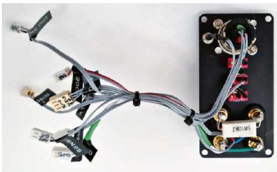
Fotografia 3. Oznaczenie wtyczki i przewody, aby ich nie pomylić podczas podłączania do gniazd na płycie. Na zdjęciu widać wyraźnie, jak podłączono rezystor odniesienia
