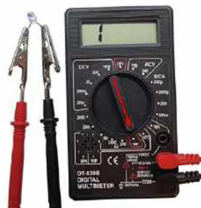
Fotografia 3. Sprawdzenie diody LED za pomocą multimetru ustawionego na funkcję testowania diod. Po przyłożeniu sondy czerwonej do anody, a czarnej do katody, sprawna dioda LED powinna się zaświecić. Jeśli dioda ma odpowiednio długie (jeszcze nie przycięte) wyprowadzenia można się wspomóc krokodylkami
