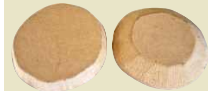
Fotografia 2. Ze ścinków (po lewej) wycięliśmy prowizorycznie dwa 120-milimetrowe dyski MDF, a następnie dopasowaliśmy je do dna miski używając tarczy szlifierskiej o ziarnistości 80 zamocowanej w akumulatorowym uchwycie wiertarskim (po prawej)
