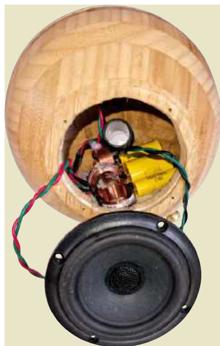
Fotografia 1. Widać, jak tunel bass-reflex, głośnik i zwrotnica są dopasowane do kulistej obudowy, która została wykonana poprzez sklejenie dwóch misek satelickich. Widać również pierścieni wzmacniający z płyty MDF za okrągłym wycięciem na głośnik
