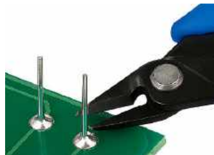
Rysunek 20. Właściwe miejsce cięcia nadmiaru wyprowadzeń po przylutowaniu komponentu. Po wykonaniu cięcia spoina powinna pozostać nienaruszona
