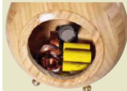
Fotografia 7. Zbliżenie pokazujące umiejscowienie płytki zwrotnicy zapewniające, że najbliższa cewka omija rurkę tunelu bass-reflex
