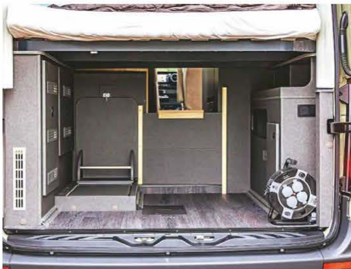
Wysokie łóżko oznacza duży garaż. Po lewej stronie znajduje się mechanizm przesuwanej toalety, która podczas jazdy pozostaje oczywiście w łazience.
