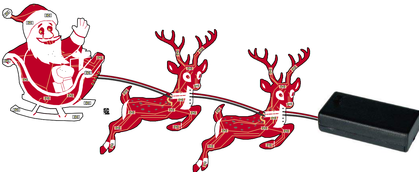
Rysunek 9. Zasililiśmy Sanie Świętego Mikołaja i dwa Renifery z pary baterii AA w obudowie Jaycar PH9280. Czerwone przewody odpowiadają napięciu +3 V, a szare 0 V; można użyć innych kolorów, tylko nie należy ich krzyżować! Ponieważ każda ozdoba pobiera mniej niż 1 mA prądu, w ten sposób można zasilać wiele innych ozdób. Układ IC1 działa w zakresie napięć od 2 V do 5,5 V, więc dobrze nadaje się do zasilania z dwóch lub trzech ogniw AA lub zasilacza USB. Jak pokazano na zdjęciu na stronie XX , podłączyliśmy go za pomocą wtyczek i gniazd, aby zapewnić elastyczność. Można jednak przylutować przewody bezpośrednio do pól lutowniczych. Najlepiej byłoby przetestować każdą ozdobę osobno przed połączeniem ich razem
