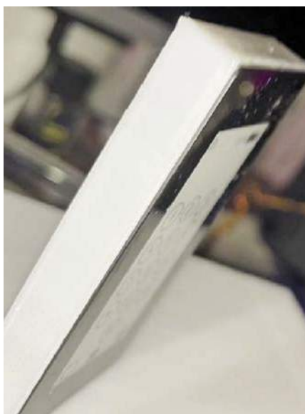
Rysunek 16. Montaż ekranu wypelnia przednią część obudowy
