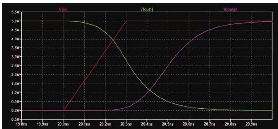
Rysunek 10. Wyniki symulacji dla układu z rysunku 9 pokazujące zmianę wejścia z 0 na 1 i odpowiedź dwóch bramek
