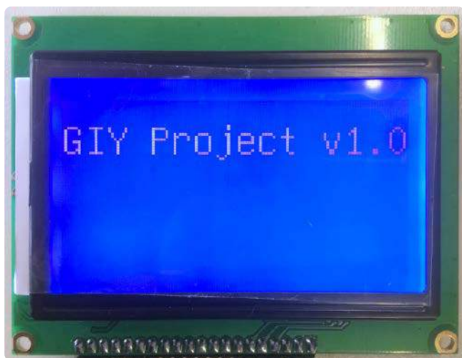
Rysunek 9. Zastosowany wyświetlacz LCD ma rozdzielczość 128×64 piksele i jest podłączony do płytki kontrolera za pomocą tylko trzech linii
