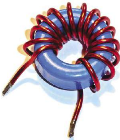
Rysunek 3.3. Autorska cewka toroidalna 1,1 mH
