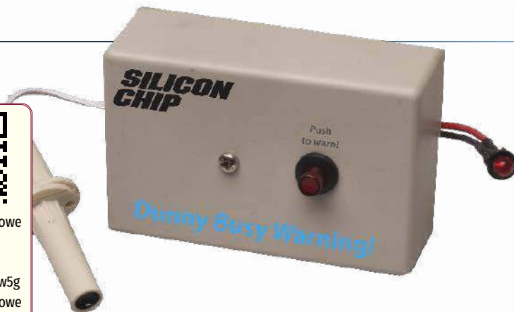
Tak, patrzysz na cały projekt! Po lewej stronie znajduje się kontaktron i magnes, które wyłączają diodę LED po otwarciu drzwi. Po prawej stronie znajduje się zamontowana na drzwiach bardzo jasna dioda LED, podczas gdy wewnętrzna dioda LED jest w tym przypadku zintegrowana z przyciskiem „Start”.
