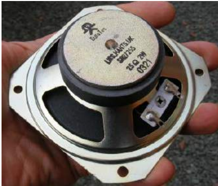
Rysunek 1. Dla wydłużenia żywotności baterii 9 V zastosowano głośnik o wysokiej impedancji (25 \Omega )
