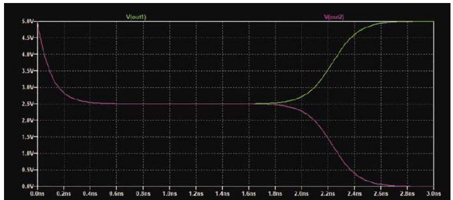
Rysunek 12. Symulacja obwodu z rysunku 11 z warunkami początkowymi v(\text{out1})=5 i v(\text{out2})=4.999999999
