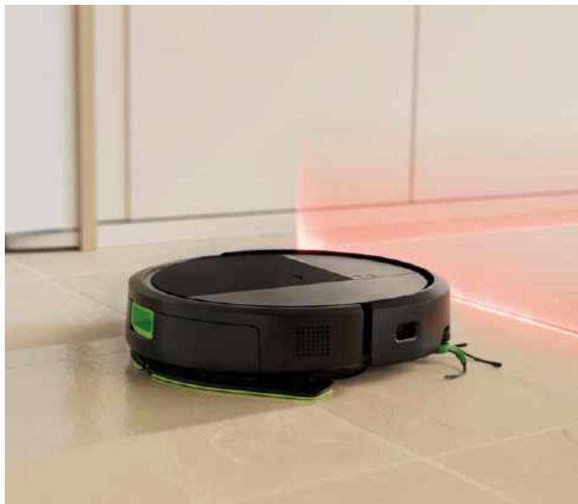
iRobot Roomba 115 Combo łączy odkurzanie i mopowanie podczas jednego przejazdu. Moc ssąca 15 000 Pa pozwala usuwać kurz, a system mopowania z technologią SmartScrub radzi sobie z trudniejszymi plamami.
