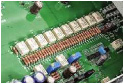
Regulator głośności złożono z przełączników (stąd wyraźne stuki towarzyszące regulacji) oraz baterii precyzyjnych rezystorów.
