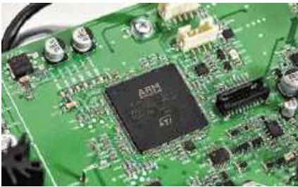
Procesor DSP firmy STMicroelectronics zajmuje się obróbką cyfrowych sygnałów audio.
