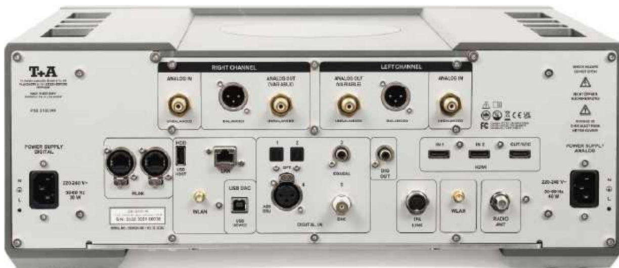
PSD 3100 HV ma metalową obudowę, więc aby uruchomić transmisję Wi-Fi (a także Bluetooth), zainstalowano zewnętrzne anteny (podłączamy je do gniazd z tyłu obudowy). Dwa złącza zasilające (z lewej i prawej strony) wynikają z bezkompromisowej konstrukcji zasilacza, który składa się z dwóch niezależnych obwodów dla sekcji analogowej i cyfrowej.
