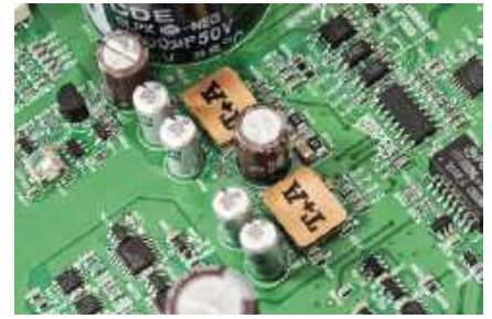
Pod złotymi, ozdobnymi osłonkami znajdują się najprawdopodobniej przetworniki dla toru PCM.
