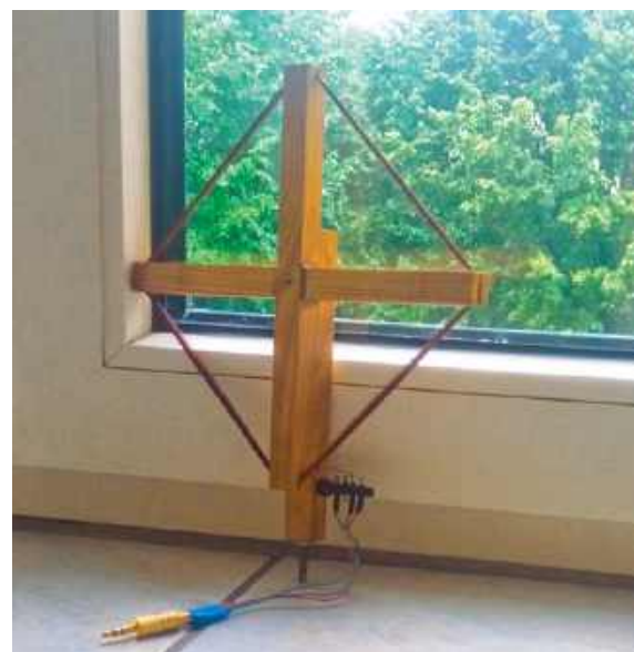
Antena krzyżakowa (uzwojenie na krzyżaku z drewna nawija się w wypilowanych szczelinach)
