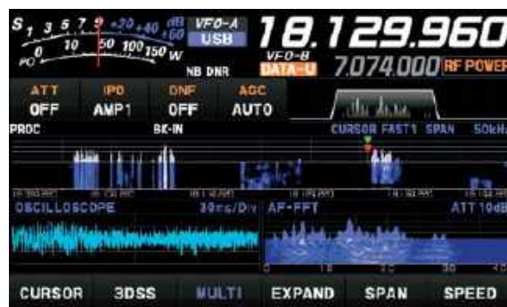
Fot. 2. Na 4,3-calowym ekranie dotykowym widoczny jest obszerny zbiór informacji
