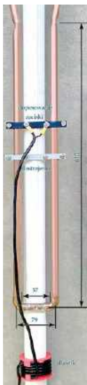
Fot. 2. Konstrukcja dolnej części anteny
