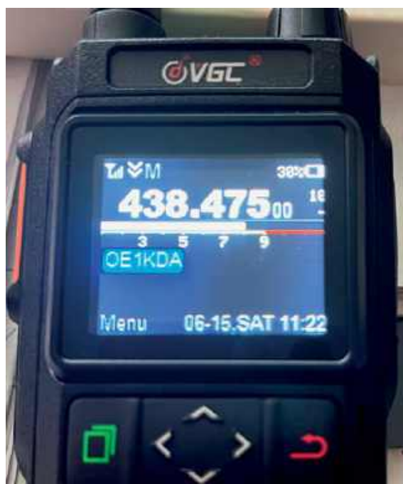
Fot. 1. Przy prawidłowym odbiorze satelitów GPS wyświetlane są data i czas
