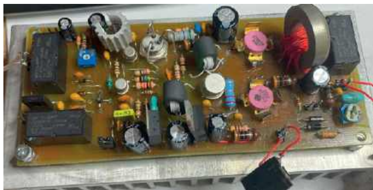
Przedwzmacniacz 3-5 W na pasmo 50 MHz wykonany przez SQ9GL. Tranzystor T4 oraz tranzystory wyjściowe T5 i T6 są wkręcone w otwory w radiatorze
