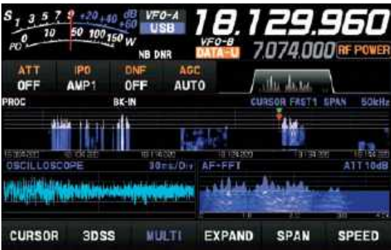
Fot. 4. Na trójwymiarowym wskaźniku widma (3DSS) wyświetlana jest historia jego zmian. Oś czasu jest skierowana w głąb, najnowsze dane znajdują się z przodu, a najstarsze w tyle
