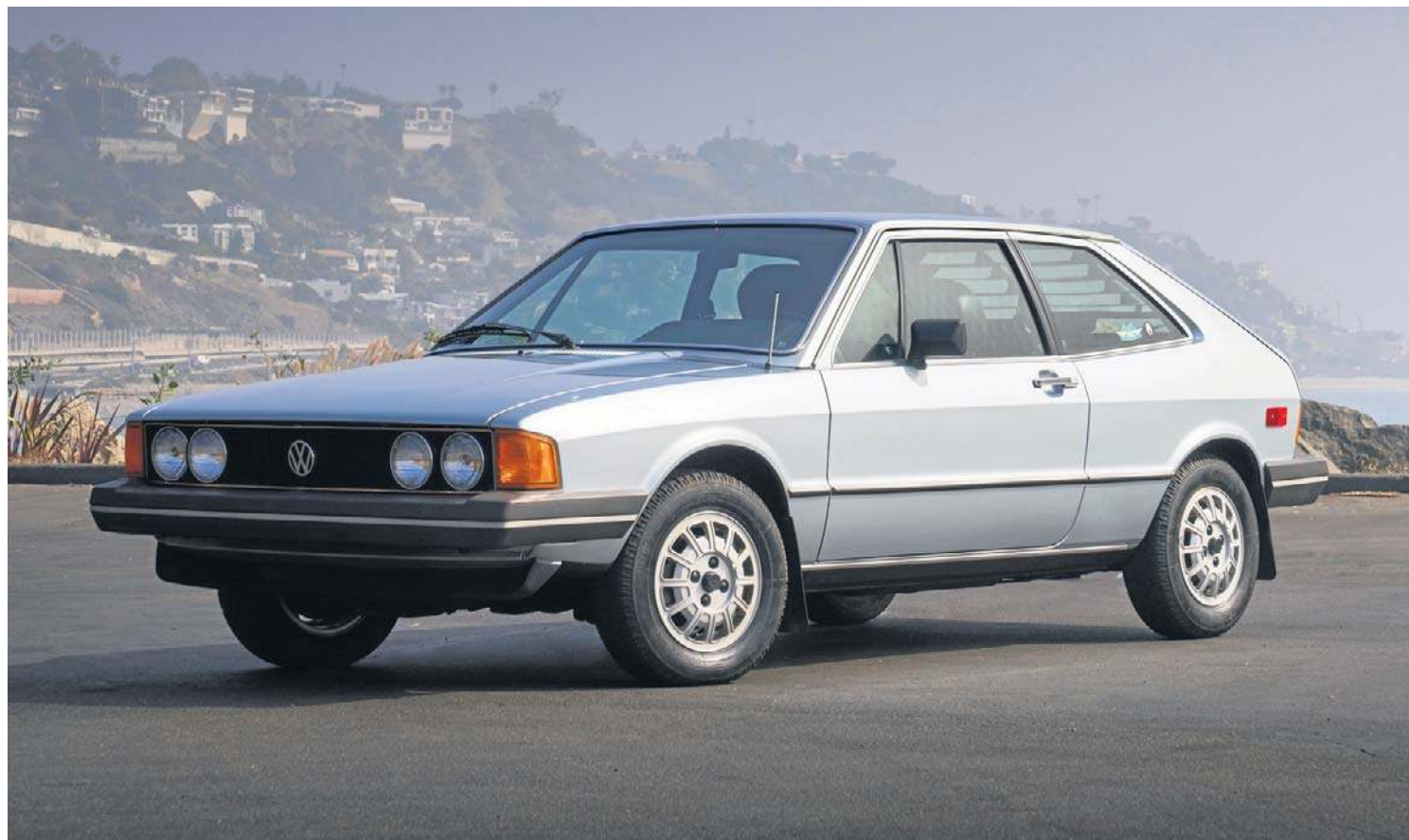
Scirocco to zdecydowanie brat Golfa. Volkswagen jako jeden z pierwszych zaczął produkować kilka modeli, wykorzystując tę samą płytę podłogową i układ napędowy. Konstruowanie samochodu stawało się prostsze, a jego produkcja tańsza
