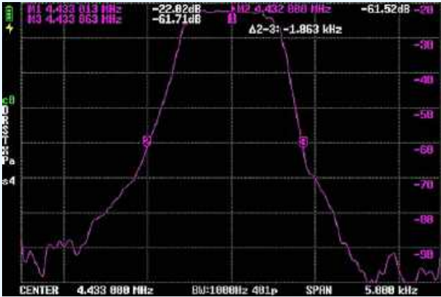
Rysunek 118. Charakterystyki częstotliwościowe tłumienności filtra SSB na częstotliwość 4,433 MHz
