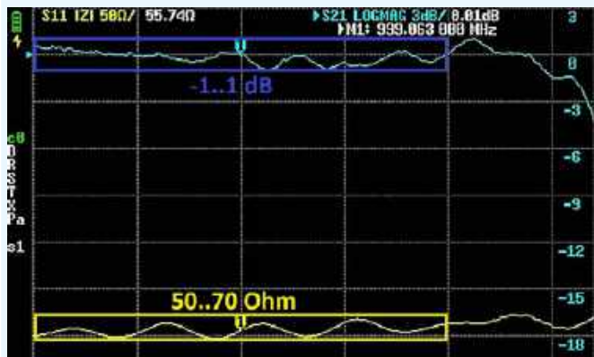
Rysunek 131. Charakterystyki częstotliwościowe tłumienia i SWR wzmacniacza LNA 0,1...2000 MHz/30 dB
