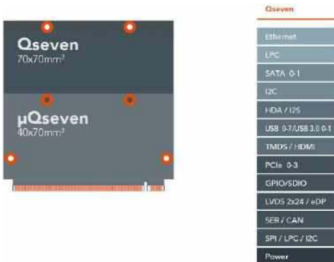
Rysunek 14. Budowa modułów SoM w standardzie Qseven oraz wykaz interfejsów i sygnałów, które mogą być dostępne na złączu krawędziowym ( https://www.congatec.com/en/technologies/qseven/ )
