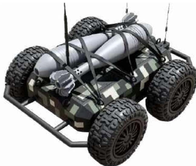
Fotografia 7. Dron Ratel S, którego zadaniem jest podjechać pod pojazd wroga i wysadzić go w powietrze. Źródło: X/Mychajło Fiodorow
