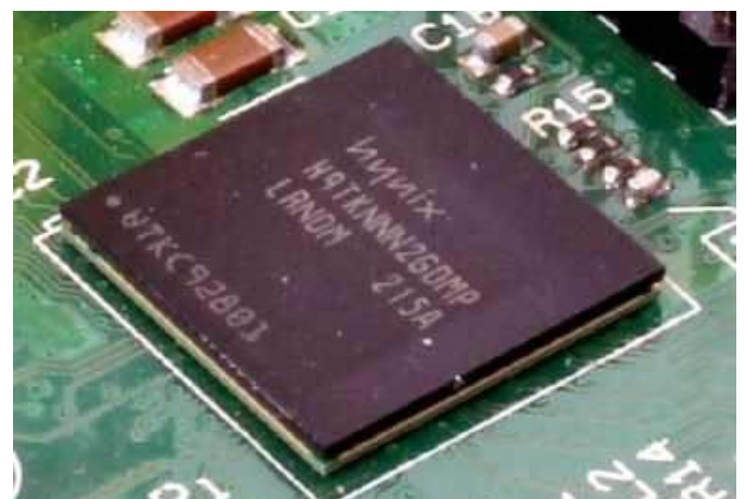
Fotografia 3. Procesor BCM2835 na płytce Raspberry Pi, wyposażony w pamięć SDRAM zamontowaną w technologii PoP ( https://de.wikipedia.org/wiki/Package-on-Package )
