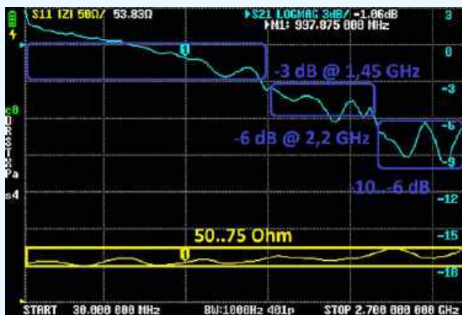
Rysunek 132. Charakterystyki częstotliwościowe tłumienia i SWR wzmacniacza LNA 30...4000 MHz/40 dB
