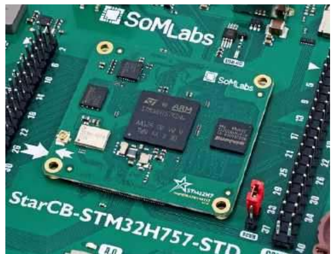
Fotografia 9. Moduł StarSOM-STM32H757 typu Board-to-Board z procesorem STM32H757XI, zamontowany na płycie bazowej ( https://somlabs.com/product/starsom-stm32h757-sls05-dual-core-arm-cortex-m7-cortex-m4/ )
