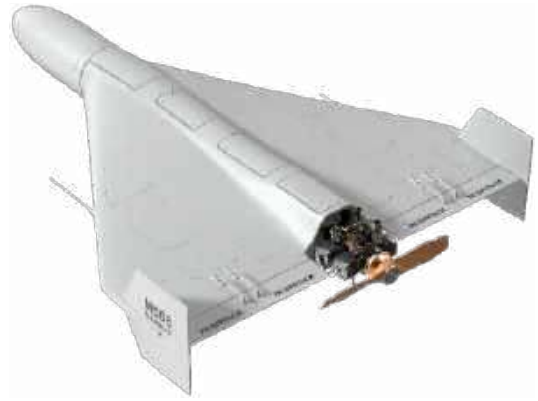
Fotografia 2. Rosyjski dron Geran-2. Występuje też w wersji czarnej za sprawą farby absorbującej sygnały radarowe
