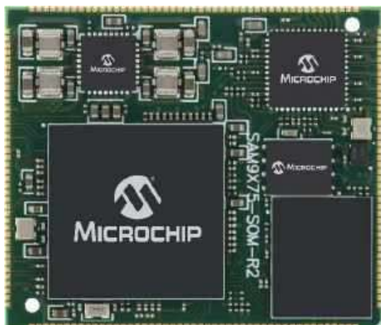
Fotografia 12. Moduł SoM SAM9X75 od Microchip ( https://www.microchip.com/en-us/product/sam9x75d2gn4 )
