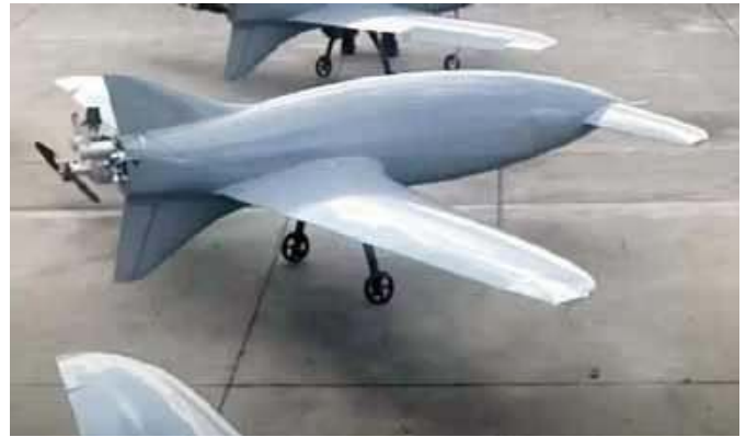
Fotografia 6. Uj-26 Bober – dron latający w układzie kaczki, oferujący dzięki temu lepsze parametry lotu. Ze względu na mniejszy rozmiar głowicy z ładunkiem wybuchowym, zwykle jest stosowany do precyzyjnych ataków
