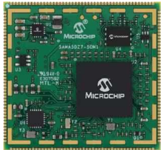
Fotografia 13. Moduł SoM SAMA5D27 od Microchip ( https://www.microchip.com/en-us/product/atsama5d27-som1 )
