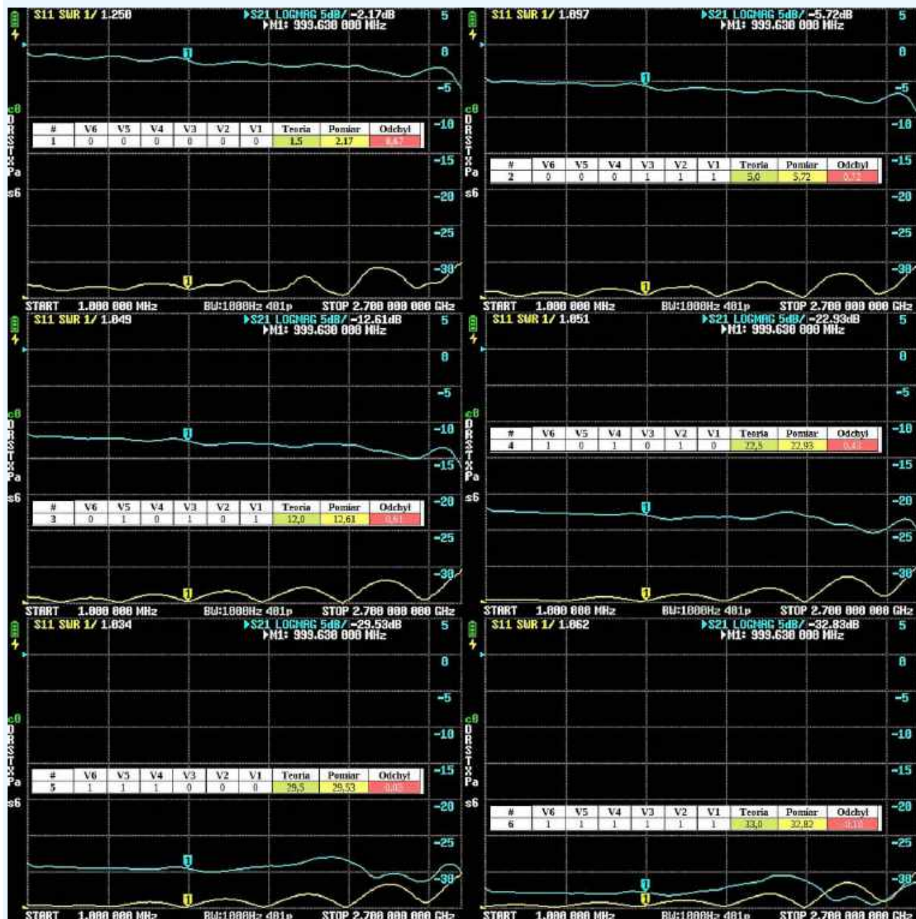
Rysunek 129. Charakterystyki częstotliwościowe tłumienności i SWR tłumika regulowanego z chipem PE4302
