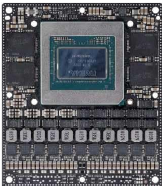
Fotografia 5. Moduł z układem SoC Nvidia Thor. Na płytce widać niezwykle rozbudowany blok zasilania, ponieważ układ Thor może pobierać moc nawet 130 W ( https://designer.antmicro.com/library/devices/nvidia-900-13834-0080-000 )
