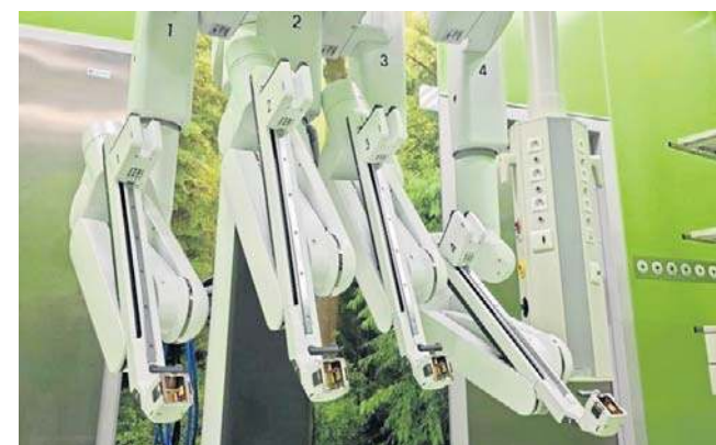
Robot chirurgiczny to rodzaj manipulatora z konsolą
