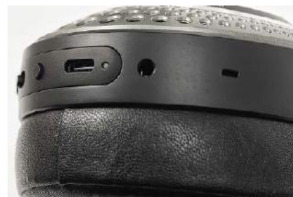
Oprócz gniazda do ładowania i cyfrowej transmisji (nowoczesne USB-C) jest też wciąż praktyczne, analogowe wejście mini-jack.
