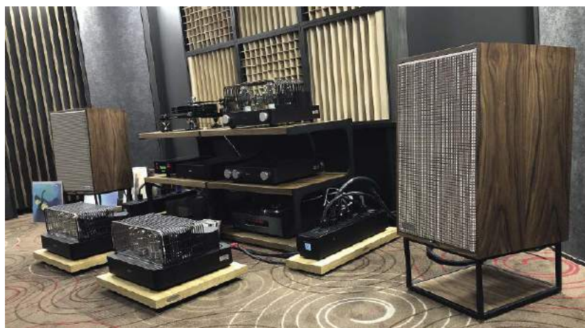
Pylon Audio znany jest z wielu nowoczesnych konstrukcji, ale w tym przypadku pochwalił się udaną stylizacją retro. Jade 20 to układ dwudrożny z 30-cm nisko-średniotonowym i kompresyjnym (tubowym) wysokotonowym. Deklarowana efektywność 91 dB, przy impedancji znamionowej 8 \Omega – do lamp jak znalazł.
