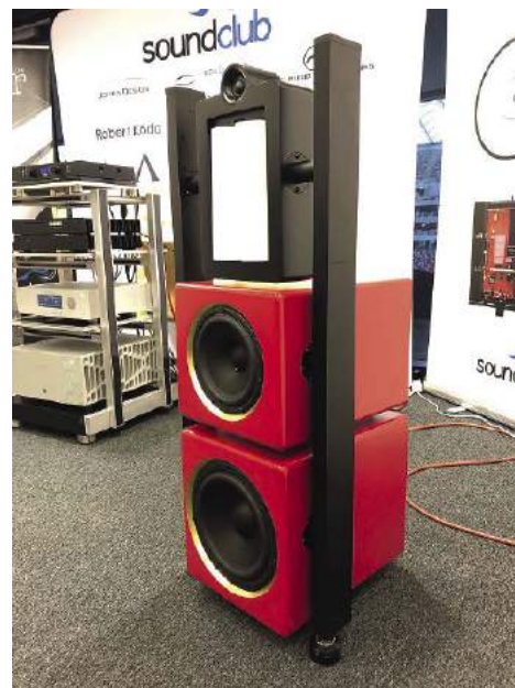
Francuskie zespoły głośnikowe AudioNec pojawiły się u nas po raz pierwszy. Konstrukcje z serii Evo to połączenie oryginalnego przetwornika szerokopasmowego DS31 DuoPole z parą modułów niskotonowych (na zamówienie dolny może być aktywny), a z drugiej strony – jedwabną kopułką wysokotonową, lecz dopiero powyżej 13 kHz.
