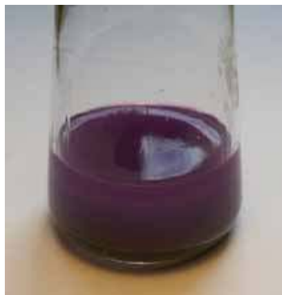
Fot. 5 – Zawiesina cynku w alkalicznym roztworze fenoloftaleiny
