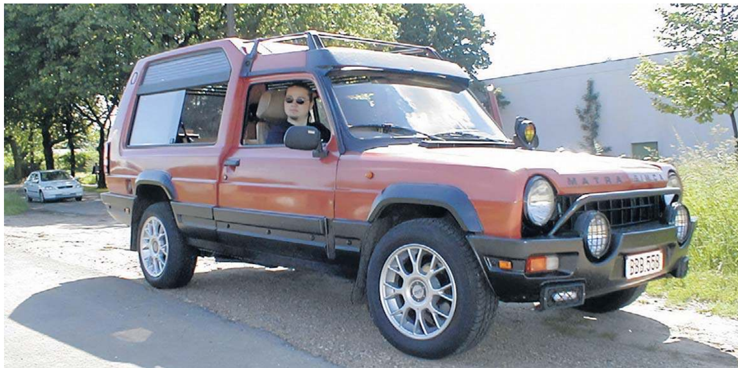
Matra Rancho – jeden z prekursorów samochodów typu SUV, produkowany w latach 1977–1984, oparty na Simce 1100. Do napędu użyto silnika o pojemności 1,4 litra, moc przenoszona była na oś przednią przez 4-biegową manualną skrzynię biegów
