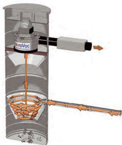
❶ Filtracja metodą separacji cyklonicznej. SANTECH
