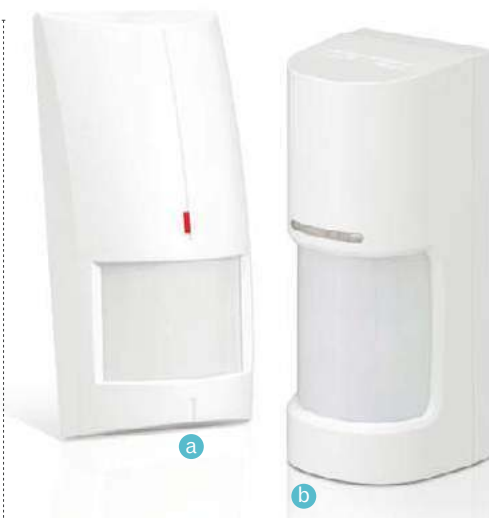
Czujka dualna, zbudowana z czujnika podczerwieni PIR i mikrofalowego (a SATEL) oraz zewnętrzna czujka PIR z dwiema strefami detekcji (b OPTEX).
