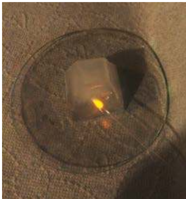
Fot. 12 – Topienie lodu płomieniem wodoru
