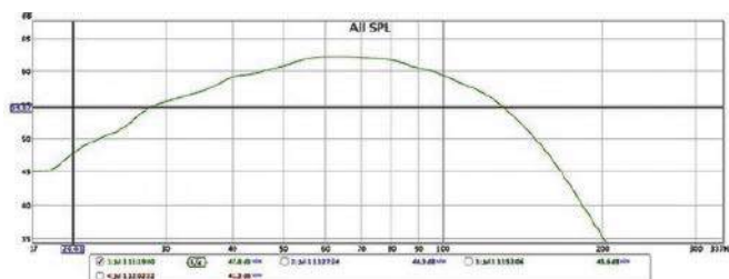
Rysunek 2. Rzeczywista charakterystyka (w przestrzeni swobodnej) testowego subwoofera zbudowanego zgodnie ze specyfikacją zastosowaną do powstania rysunku 1. Chociaż nie jest to dokładne dopasowanie, charakterystyka jest dość zbliżona i z pewnością spełnia cele projektowe. Odpowiedź zmienia się nieco, gdy subwoofer jest umieszczony w pomieszczeniu
