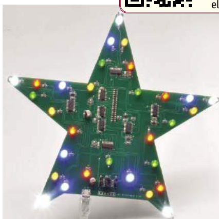
Rysunek 2. Jest to prostszy z dwóch modeli Gwiazd LED, ale zapewnia świetną prezentację z jednokolorowymi diodami LED. Dzięki diodom LED o wysokiej jasności wyświetlacz jest naprawdę jasny w pomieszczeniach przy świetle dziennym, ale to właśnie w nocy migające diody LED naprawdę się sprawdzają! Ponieważ jest zasilany niskim napięciem DC (5 V; tj. z portu USB), może być również używany na zewnątrz. Nawiasem mówiąc, kamera widzi białe diody LED jako znacznie jaśniejsze, ale w rzeczywistości ich wzajemna jasność jest całkiem dobrze dopasowana
