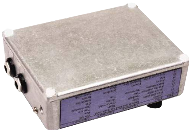
Rysunek 10. Widok gotowej przystawki ustawionej do góry nogami. Podstawa pudełka staje się panelem przednim (z odpowiednią etykietą), a pokrywa pudełka, z czterema poliamidowymi śrubami używanymi jako nóżki, staje się podstawą. Etykiety przymocowane z każdej strony ułatwiają wybór efektu
