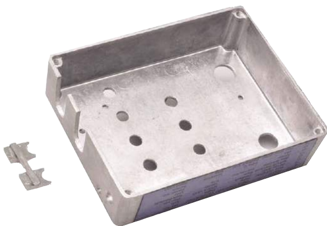
Rysunek 8. W odlewanym pudełku należy wywiercić kilka otworów – szczegóły można znaleźć na szablonie wiercenia (rysunek 7). Należy również zwrócić uwagę na „wypełnienie” lub zaślepkę – pomaga to uszczelnić pudełko po umieszczeniu w nim płytki drukowanej
