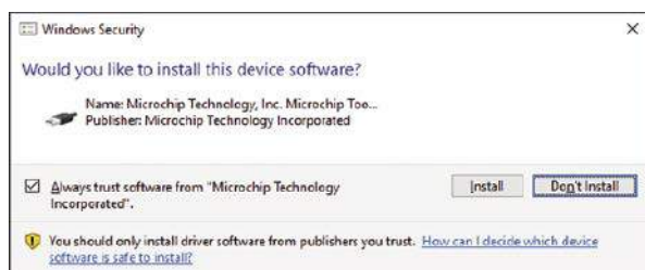
Rysunek 3. MPLAB X instaluje również sterowniki dla urządzeń takich jak programatory typu PICkit 4 i interfejs programowania dla Curiosity Nano AVR128DA
