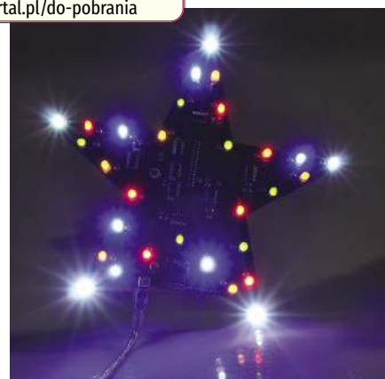
Rysunek 2. Jest to prostszy z dwóch modeli Gwiazd LED, ale zapewnia świetną prezentację z jednokolorowymi diodami LED. Dzięki diodom LED o wysokiej jasności wyświetlacz jest naprawdę jasny w pomieszczeniach przy świetle dziennym, ale to właśnie w nocy migające diody LED naprawdę się sprawdzają! Ponieważ jest zasilany niskim napięciem DC (5 V; tj. z portu USB), może być również używany na zewnątrz. Nawiasem mówiąc, kamera widzi białe diody LED jako znacznie jaśniejsze, ale w rzeczywistości ich wzajemna jasność jest całkiem dobrze dopasowana
