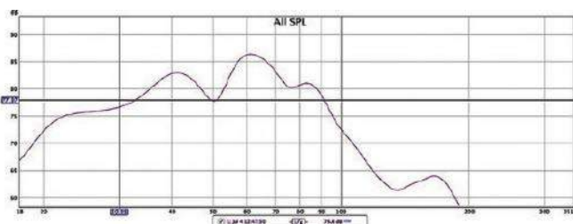
Rysunek 3. Odpowiedź pomieszczenia, a porównując ją z rysunkiem 2, można zobaczyć fale stojące utworzone przez niektóre częstotliwościach przez fale dźwiękowe odbijające się od twardych powierzchni wewnątrz pomieszczenia. Skutkuje to szybszym spadkiem emisji wysokich tonów, ale także użytecznym podbiciem niskich tonów
