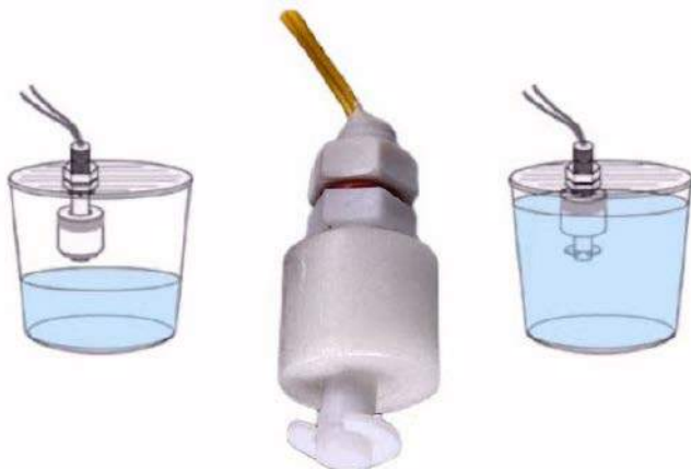
Rysunek 3. Wygląd i działanie pionowego łącznika pływakowego (© 2020 Jos Verstraten)
