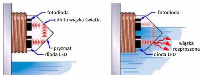
Rysunek 17. Działanie czujnika elektrooptycznego (© eptsensor.com)
