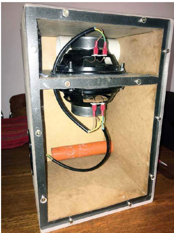
Rysunek 11. Ten głośnik testowy został zbudowany z grubym kawałkiem płyty akrylowej zamiast jednego z paneli bocznych MDF. Umożliwiło to Autorowi obserwację wychYLENIA głośników. Upewnij się w ten sposób, że nie jest ono nadmierne
