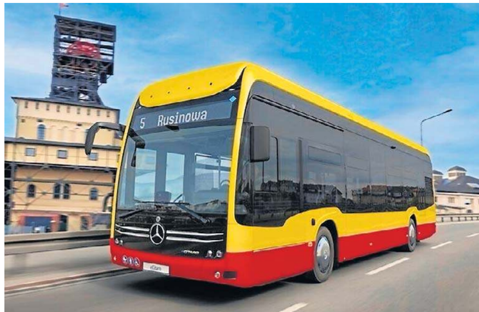
Mercedes łączy moc baterii trakcyjnych z paliwowym ogniwem wodorowym, tworząc zaawansowaną, zeroemisyjną hybrydę nowej generacji
