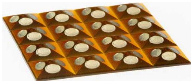
Fotografia 41. Trójwymiarowa struktura macierzy antenowej, wyprodukowana metodą wytwarzania przyrostowego z użyciem drukarki DragonFly IV ( https://t.ly/5X_02 )
