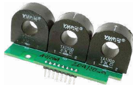
Fotografia 2. Zmontowana płytkę przekładników TA1020
