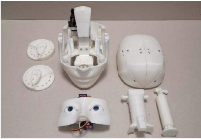
Fotografia 5. Wstępny montaż głowy robota InMoov
