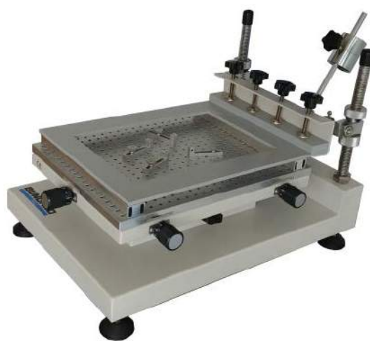
Fotografia 44. Manualna drukarka pasty lutowniczej – model PRINTSTAR 3000 ( https://t.ly/h9NE1 )
