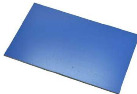
Fotografia 22. Formatka laminatu światłoczułego, pokryta folią ochronną ( https://t.ly/9Vxpu )
