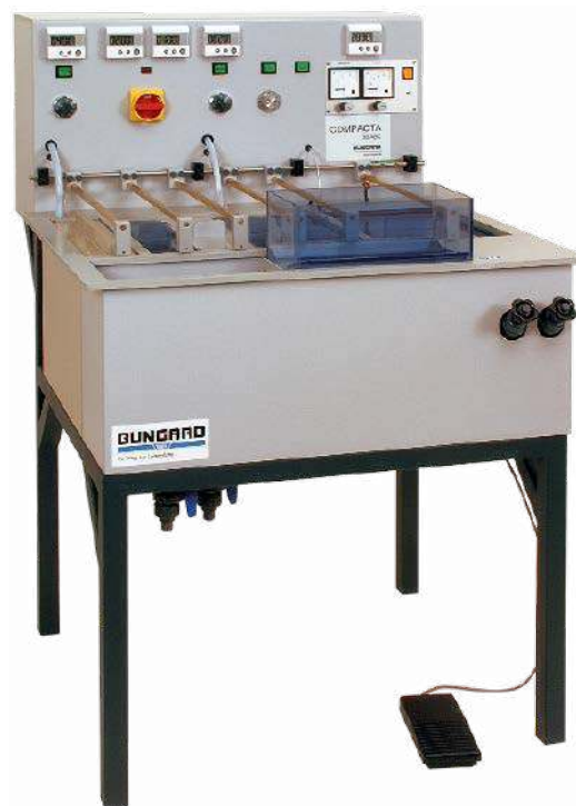
Fotografia 28. Maszyna do metalizacji otworów Compacta 30 marki Bungard ( https://t.ly/77cZk )
