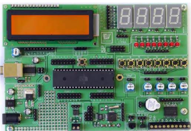
Fotografia 10. Płyta ewaluacyjna do mikrokontrolerów ATmega16 marki Gotronik ( https://t.ly/Z2g37 )
