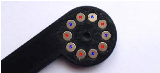
Rysunek 2. Ułożenie magnesów w sensorze
