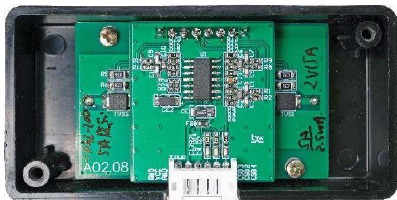
Fotografia 3. Zmontowana płytkę wzmacniacza pomiarowego połączona z płytką przekładników i umieszczona w obudowie
