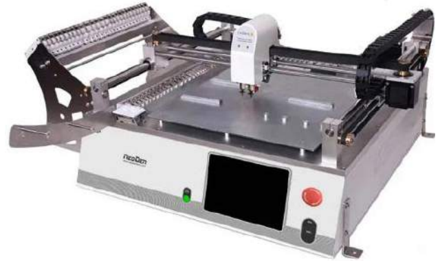
Fotografia 47. Kompaktowy automat pick & place – NeoDen 3V-A ( https://t.ly/SEfMK )
