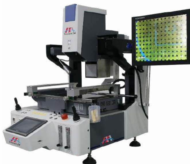
Fotografia 43. Profesjonalna stacja robocza BGA ( https://t.ly/b_0kF )
