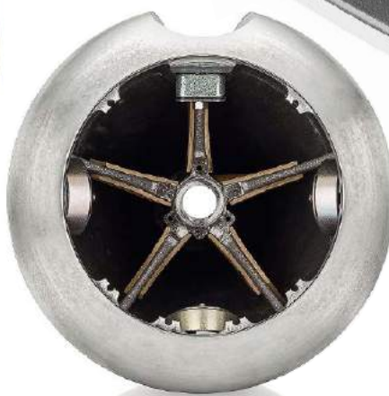
Widok wnętrza głowy od frontu - w głębi mocowanie głośnika, na ściankach tłumiki masowe.
