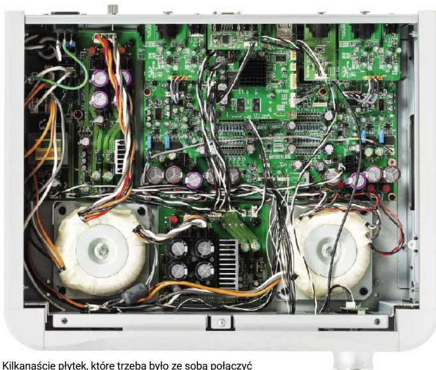
Kilkanaście płytek, które trzeba było ze sobą połączyć – w takiej sytuacji liczba przewodów i tak jest zżęcznie ograniczona.
