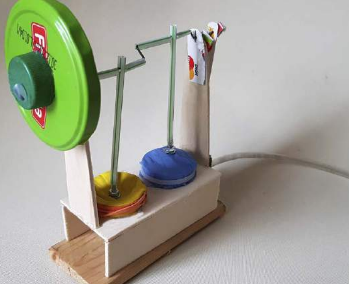
18. Do suwaka doklejona rurka doprowadzająca sprężone powietrze, 19. Model gotowy do pracy
