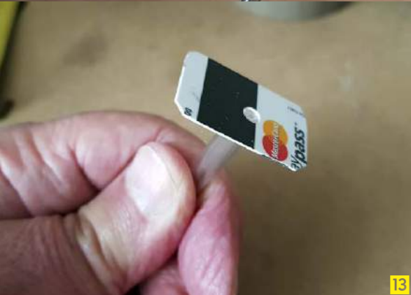
10. Rozrząd i suwak obok przednia pokrywa suwaka, 11. Łączenie uchwytu suwaka z korbą suwaka, 12. Wiercenie otworu w górnej części korby, 13. Dodatkowy panel przedni suwaka z wklejoną rurką igielitową
