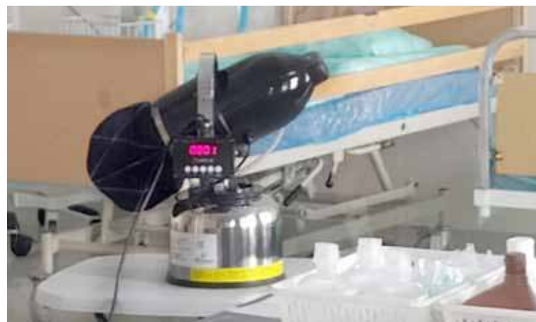
Urządzenie w określonym czasie potrafi wyprodukować tzw. suchą mgłę, która za zadanie ma dezynfekować pomieszczenia
