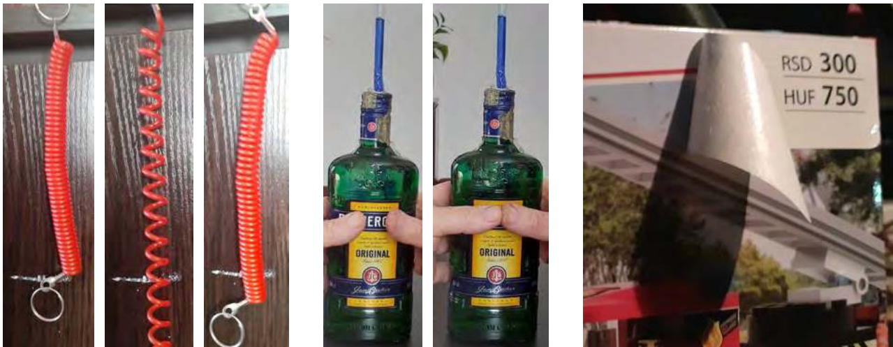
Ryc. 8. (a, b) Dwa doświadczenia z ciałami stałymi. (a) Polimer, który wykazuje histerezę kształtu: sprężyna rozciągnięta do 4-krotnej długości, po usunięciu siły potrzebuje kilkunastu sekund, aby wrócić do pierwotnego rozmiaru (środkowa fotografia zrobiona 3 sekundy po usunięciu siły rozciągającej). (b) Sprężystość szkła. Płaska butelka o pojemności 500 cm 3 , ściśnięta „z całej siły” dwoma kciukami zmniejsza swą objętość o około 0,5 cm 3 . Dla lepszej wizualizacji warto użyć węższej słomki. Idea: mgr Hieronim Ratajczak. Foto: M. Karwasz, kciuki GK. (c) Klej to też ciecz nie-newtonowska: zrywając etykietę z pudełka z zabawkami należy ciągnąć powoli – wówczas klej „płynie” pod wpływem niewielkiej siły a papier nie zrywa się (= kolejna kompetencja praktyczna).
