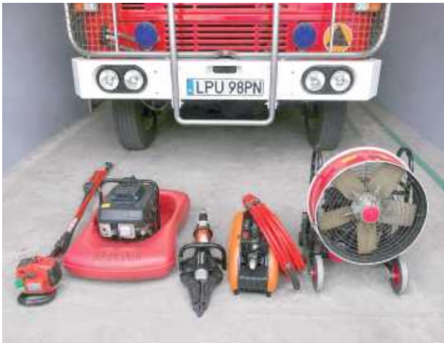
Nowy sprzęt w remizie OSP Janowice – wśród przekazanego wyposażenia znalazły się m.in. motopompa, agregat oddymiający, piła na wysięgniku oraz narzędzia hydrauliczne
