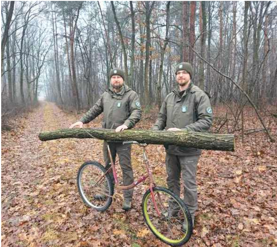
Niedaleko miejsca, gdzie wycięto drzewa, strażnicy znaleźli ten oto rower przygotowany do przewożenia klocków. Jednośląd został pozbawiony pedałów i łańcucha, czyli elementów, w które coś mogłoby się zaplątać, a zamiast siodła ma przyspawany uchwyt w kształcie litery U. Strażnicy na zdjęciu prezentują, w jaki sposób sprawca kradzieży wywoził drewno z lasu, nie pozostawiając śladu
