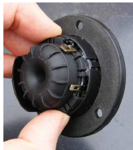
Rysunek 2. Głośnik wysokotonowy Wavector TW022WA04 jest niewielki dzięki zastosowaniu pierścieniowego magnesu z metali ziem rzadkich.
