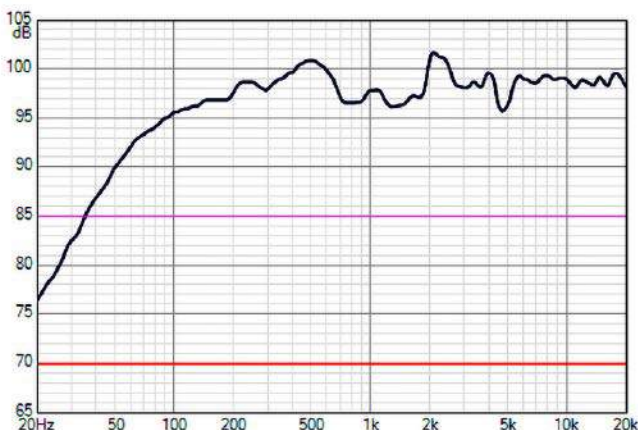
Rysunek 1.20. Wypadkowa charakterystyka poziomu ciśnienia akustycznego w funkcji częstotliwości zestawu głośnikowego w obudowie typu „Zeus” (wszystkie głośniki podłączone synfazowo)
