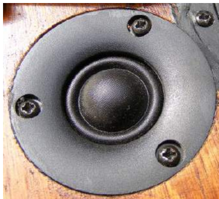
Rysunek 5. Zamontowany głośnik wysokotonowy Wavecora TW022WA04 do mini-monitora PE.
