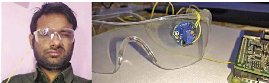
Rysunek 2. Autor testuje działanie czujnika zamknięcia powieki prawego oka
