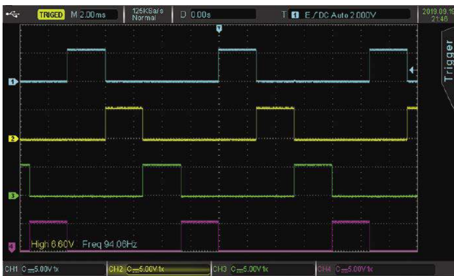
Rysunek 22. Przebiegi 1-4 dla wyjść od Q0 do Q3 układu 4017.
