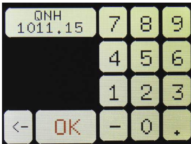
Ekran 4. Aktualna wartość QNH jest wyświetlana podczas wpisywania nowej wartości, aby przypomnieć, którą wartość aktualizujesz.
