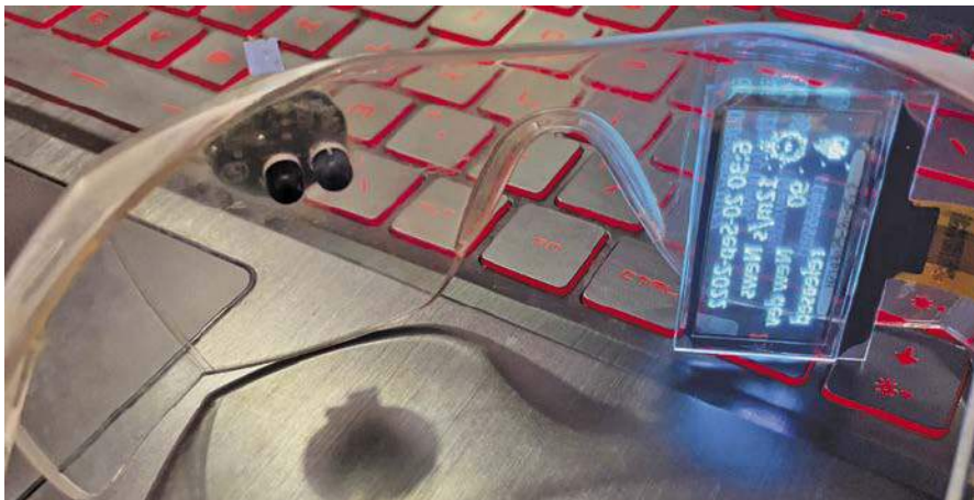
Rysunek 2. Prototyp „Smart Okularów” autora
