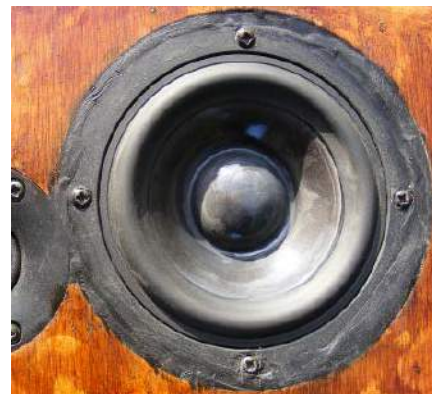
Rysunek 6. Głośnik niskotonowy Wavecora WF120BD06 do mini-monitora PE oraz front głośnika niskotonowego Wavecora zamontowany w skrzyni (proszę zwrócić uwagę na membranę z dopingiem).
