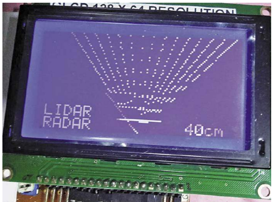
Rysunek 3. Ekran prototypu wykonanego przez autora pokazuje odległość i kąt skanowania Lidaru
