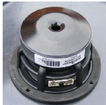
Rysunek 7. Widok tyłu głośnika niskotonowego Wavecora WF120BD06; zauważ obszerne odpowietrzenie.
