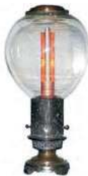
Fotografia 5, 6. Świeca Jabłoczkowa z 1876 r. (data patentu), która jako praktyczne źródło światła wykorzystywana była w latach ulicznych i jej twórca Źródło: https://pl.wikipedia.org/wiki/Pawie%C5%82_Jab%C5%82oczkow
