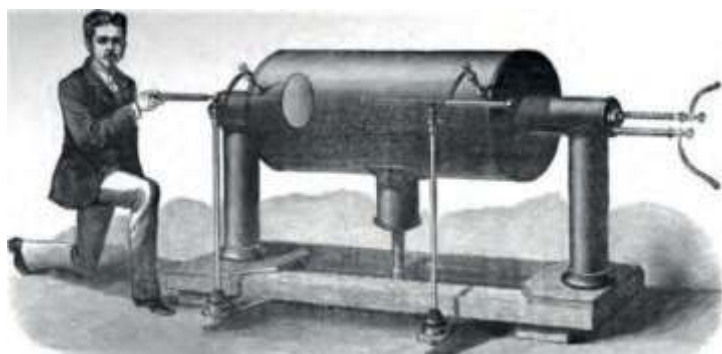
Fotografia 3. Jedna z największych cewek, zbudowana w 1877 r. przez Alfreda Apps dla Williama Spottiswoode. Nawinięta drutem o długości 280 mil może wytworzyć iskrę 42 cale (106 cm), co odpowiada około milionowi voltów.
